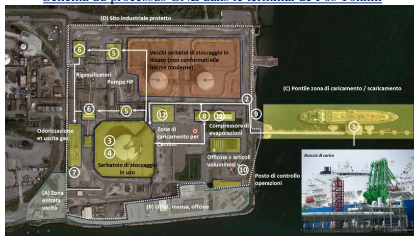
Schéma du processus GNL dans le terminal de Fos Tonkin
