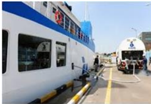
Figura 11. Rifornimento di GNL secondo configurazione TTS.
