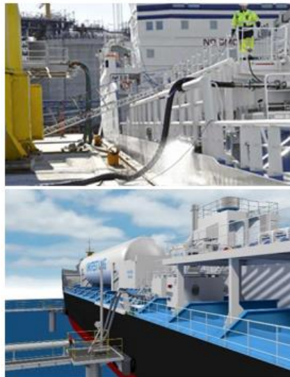
Figura 15. Rifornimento di GNL secondo configurazione PTS.
