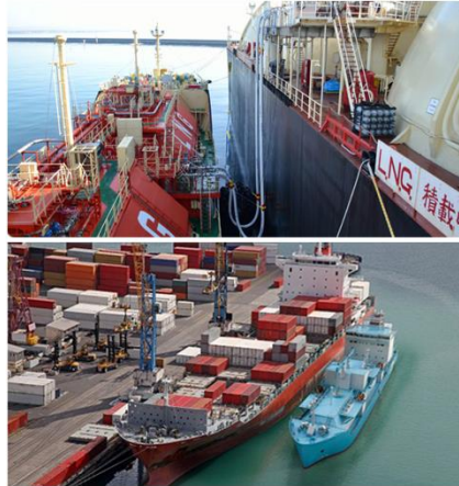
Figura 13. Rifornimento di GNL secondo configurazione STS
