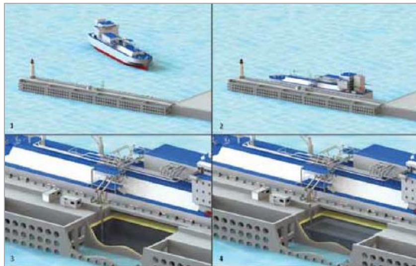
Figure 4. Quai d'amarrage avec réservoirs de stockage de GNL
