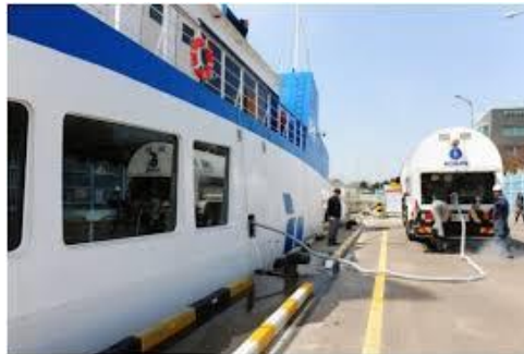
Figure 28. Approvisionnement en GNL selon la configuration TTS
