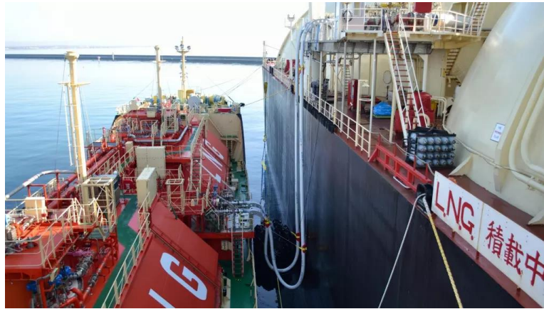
Figure 26. Approvisionnement en GNL selon la configuration STS
