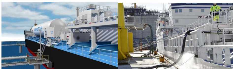
Figure 29. Approvisionnement en GNL selon la configuration PTS
