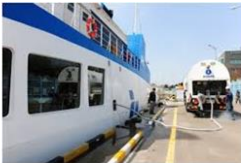
Figure 52: Approvisionnement en GNL selon la configuration TTS
