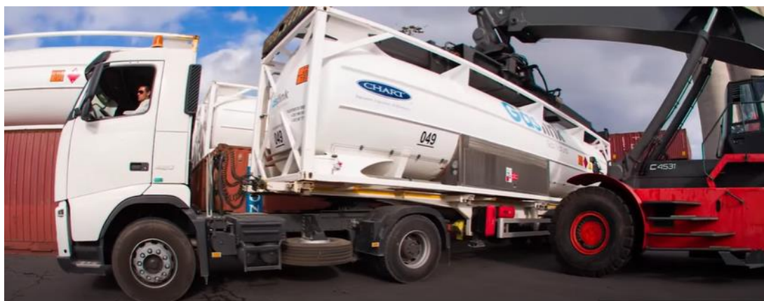
Figure 4 : Dépose d'un ISO-conteneur GNL sur un camion (source : Chart Industries)
