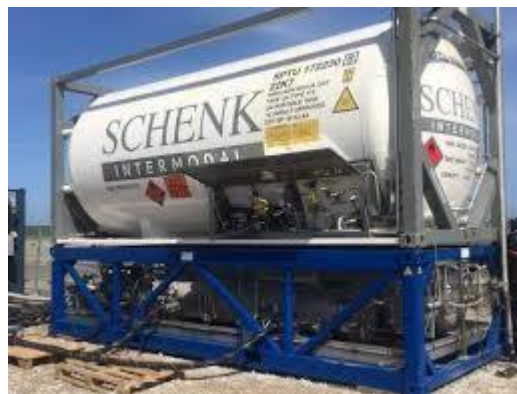
FIGURE 3 - ISO-CONTENEUR SUR SKID
