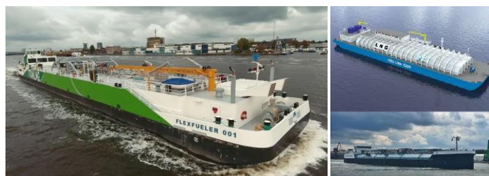
Figure 14: Exemple de "Barges bunker de petite taille (1.000-3000 m 3 )"
