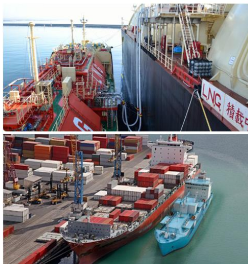
Figure 5: Approvisionnement en GNL selon la configuration STS
