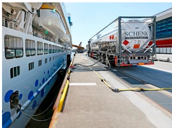
FIGURE 4 - AVITAILLEMENT AIDAPRIMA DANS LE PORT DE HAMBOURG, 2016
