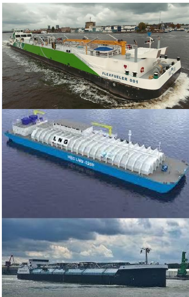
FIGURE 15 - DE HAUT EN BAS: FLEXFUELER - 1.500 M 3 , CLEAN JACKSONVILLE - 2.200 M 3 , LNG LONDON - 3,000 M 3
