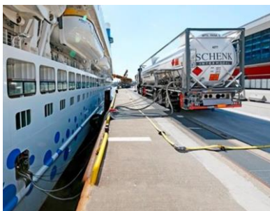
Figure 53: exemple de bunkering operation via Iso-container par route
