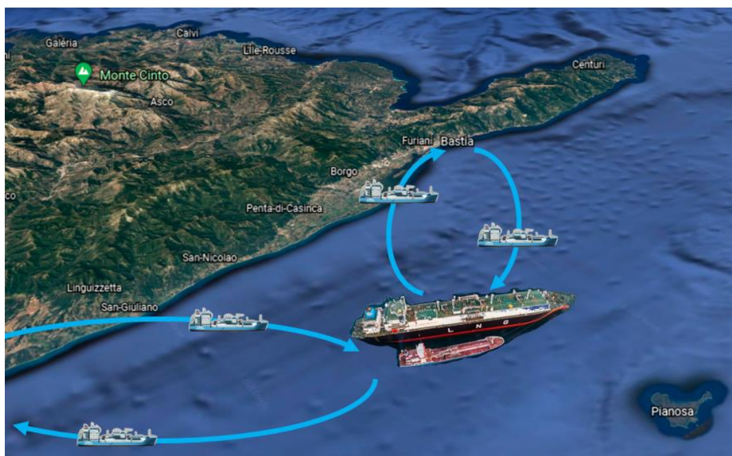
Figure 9 : Solution 2 pour la Corse – soutage par navire souteur dédié
