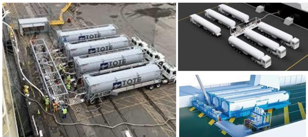
Figure 95: Exemple de système Iso container/citernes sur multi-track
