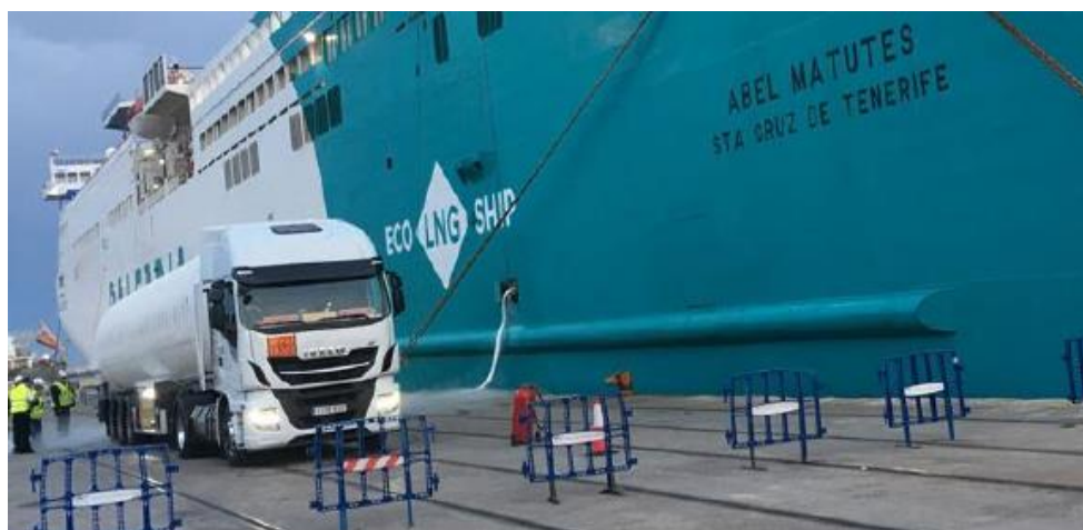
Figure 7 : Soutage à l'aide d'un flexible cryogénique à partir d'un camion-citerne
