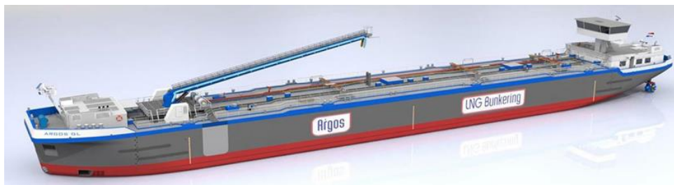
Figura 28. Nave per il rifornimento di GNL della Argos secondo configurazione STS: rendering.
