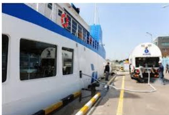
Figura 29. Rifornimento di GNL secondo configurazione TTS
