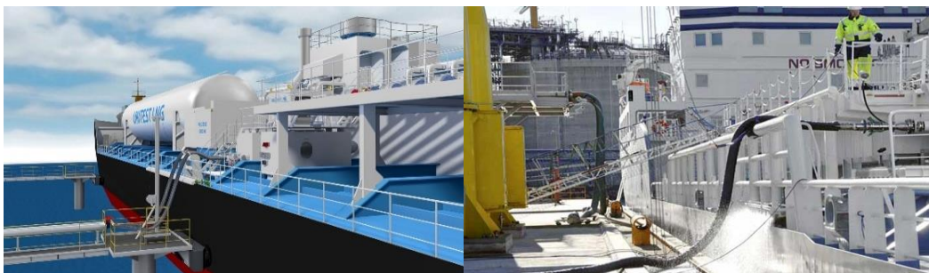
Figura 30. Rifornimento di GNL secondo configurazione PTS
