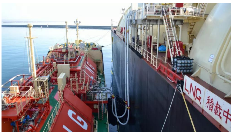
Figura 27. Rifornimento di GNL secondo configurazione STS
