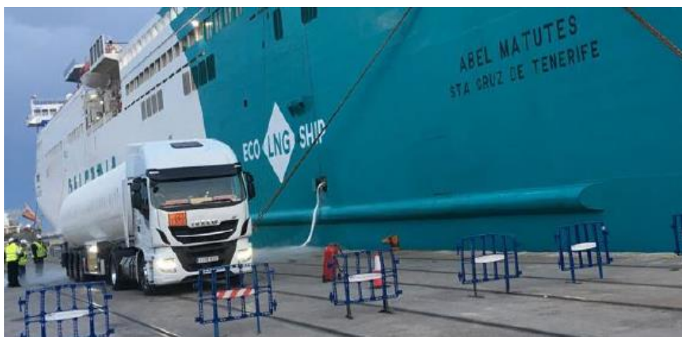
Figura7: Bunkeraggio con tubo criogenico da motocisterna
