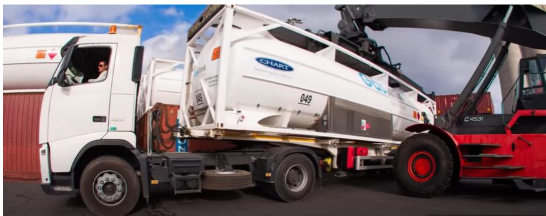
Figura4: Carico di un ISO-container GNL su un autocarro (fonte: Chart Industries)
