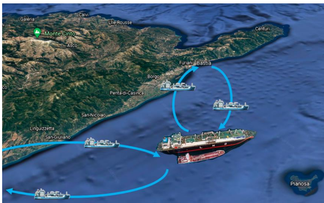
Figura9: Soluzione 2 per la Corsica - bunkeraggio con nave bunker dedicata
