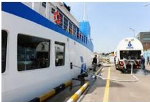
Figura 52: Rifornimento di GNL secondo configurazione TTS
