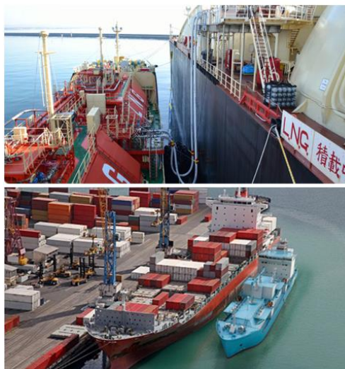
Figura 5: Rifornimento di GNL secondo configurazione STS
