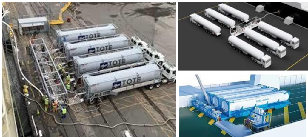
Figura 95: Esempio di sistema Iso container/cisterna su multi-track
