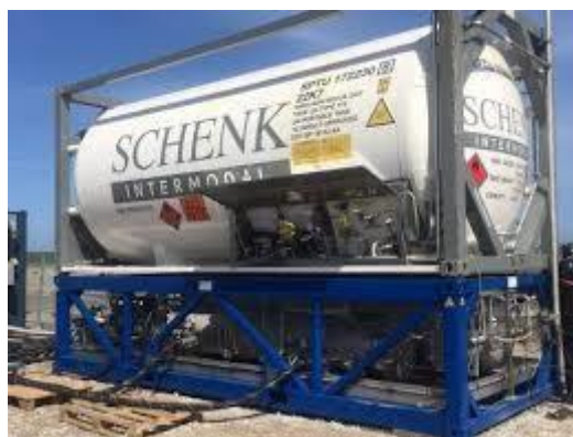
Figura 73: Esempio di ISO container GNL su skid
