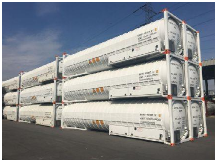
Figura6: Accatastamento di ISO-container GNL
