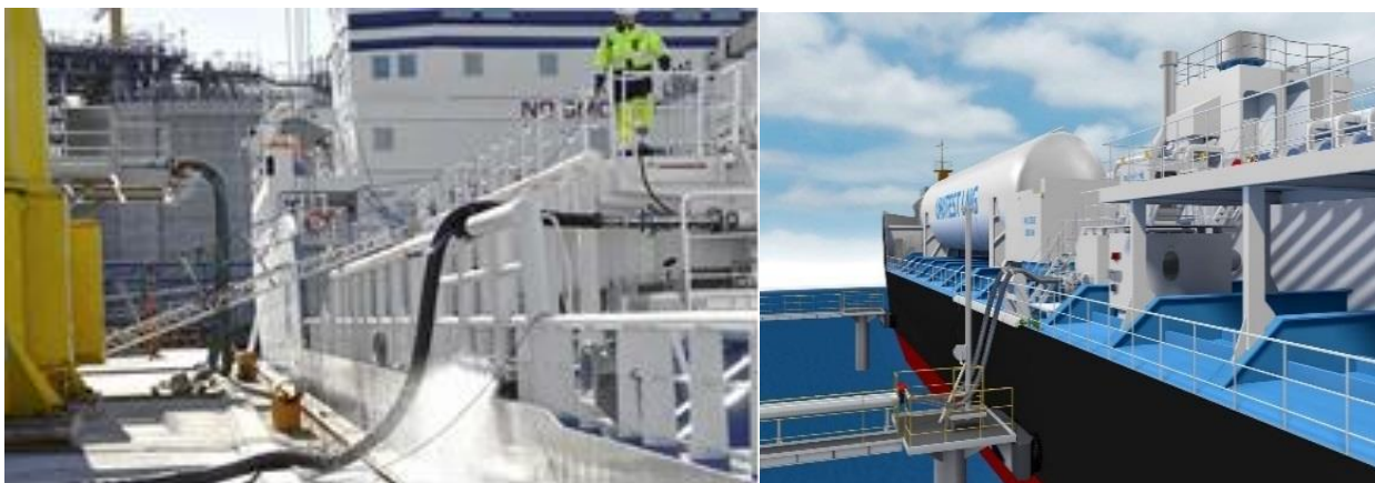
Figura 107: Rifornimento di GNL secondo configurazione PTS
