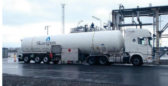
Figura 5- Bunkeraggio mediante ATB
