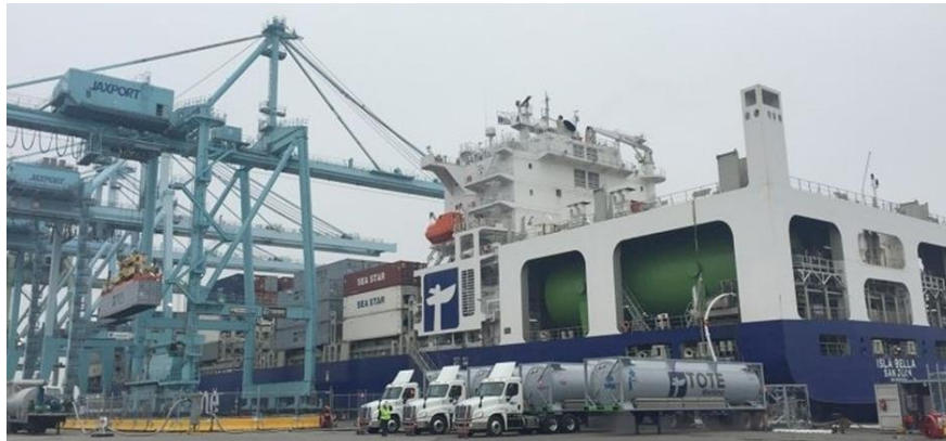
Figura 13. Configurazione TTS con l'impiego di diverse autobotti
