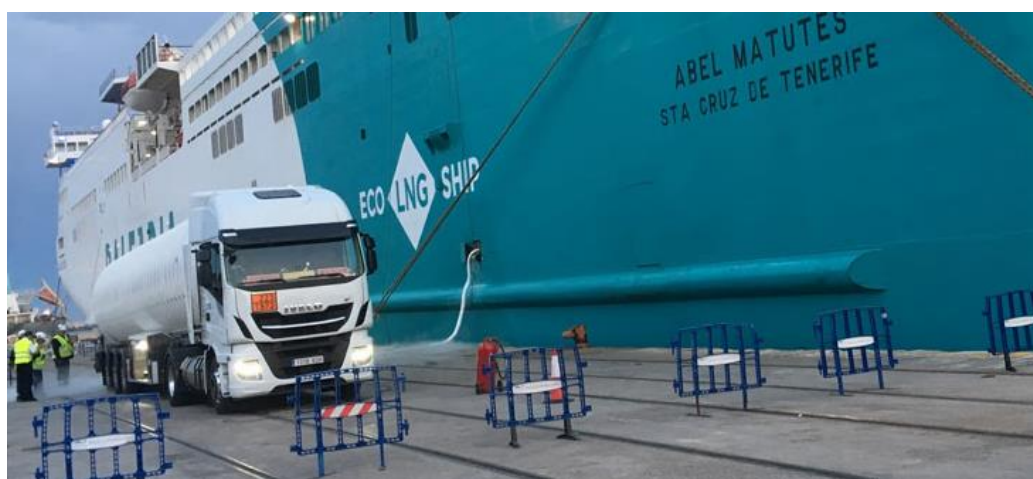
Figura 12. Rifornimento di GNL secondo configurazione TTS
