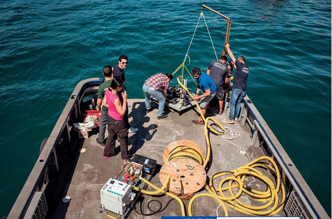
**PHOTO 30-31-32** Au cours du projet SPaSH! a également été étudié, conçu et réalisé le prototype d'un instrument visant à échantillonner les microplastiques dans la colonne d'eau à différentes profondeurs et en série. Ces images présentent l'instrument réalisé et le test effectué dans le port de Gênes.
