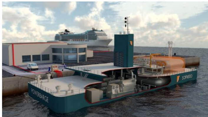
Figura 7-4: Esempio di bettolina per la fornitura di energia elettrica alle navi attraccate
