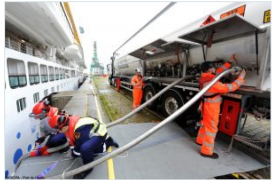
Figura 6-3: Rifornimento a GNL di una nave di linea, maggio 2016
