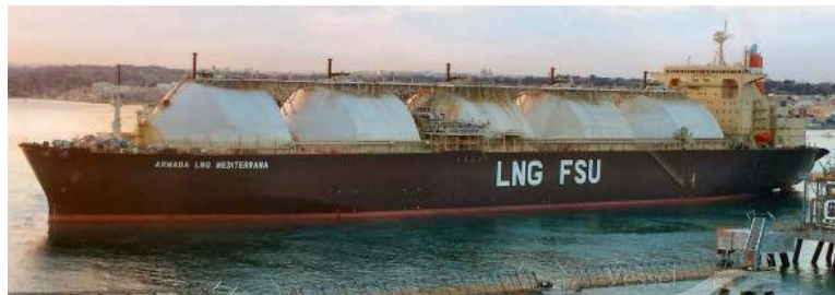
Figura 5-20: Unità galleggiante ancorata - FSU
