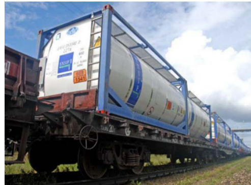
Figura 5-10: Esempio di trasporto di GNL su ferrovia: carro cisterna per GNL o container ISO
