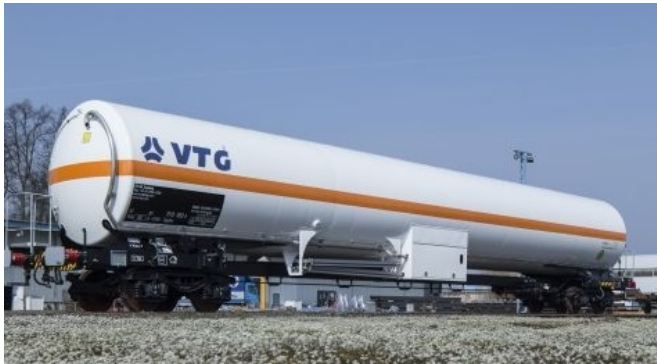
Figura 5-10: Esempio di trasporto di GNL su ferrovia: carro cisterna per GNL o container ISO
