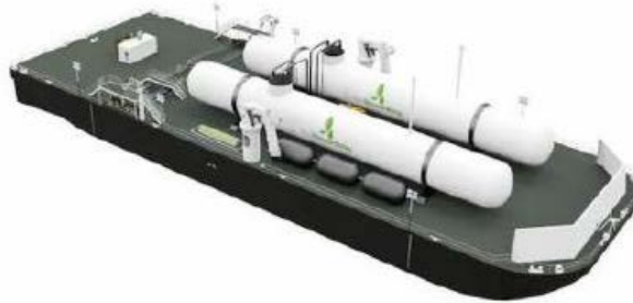
Figura 6-8: Bettolina di trasferimento dotata di serbatoio di tipo C
