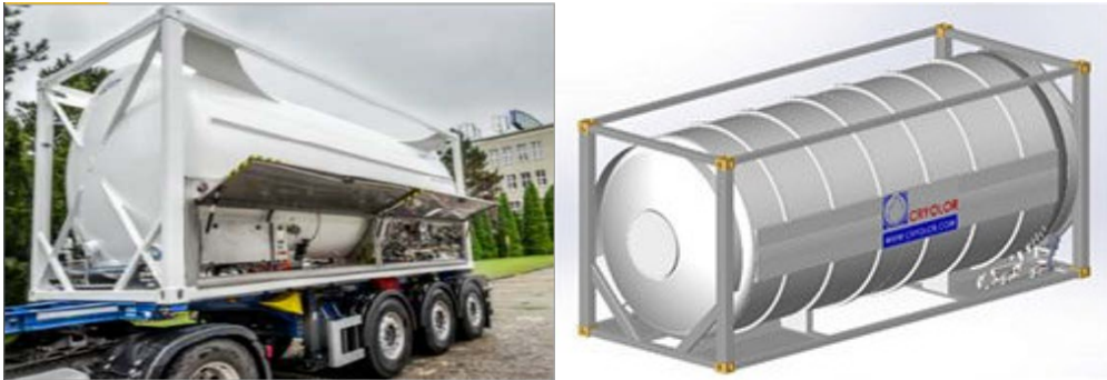
Figure 5-3 : Camion et ISO Tank GNL
