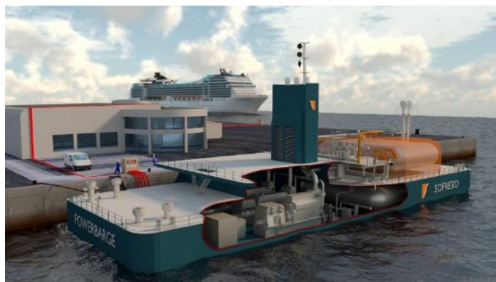
Figure 7-4 : Exemple de barge permettant d'alimenter les navires à quai en électricité
