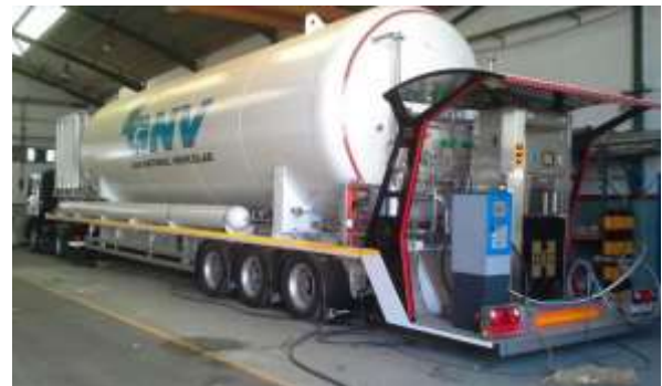
Grafico 13 : foto di una stazione mobile GNL realizzata da HAM
