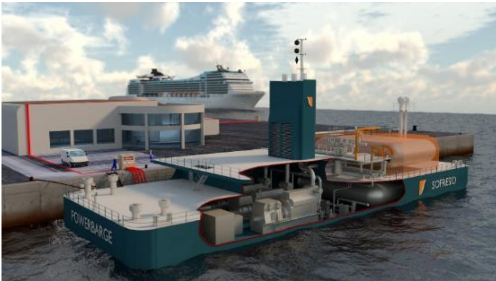
Figura 65 - Esempio di battolina per la fornitura di energia elettrica alle navi attraccate
