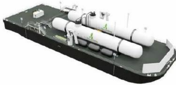
Figura 60 - Bettolina di trasferimento dotata di serbatoio di tipo C
