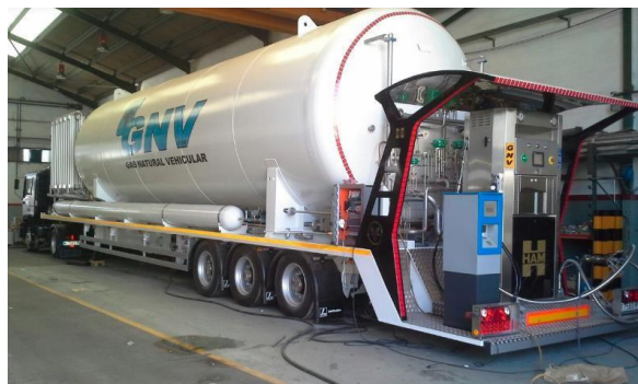
Figura 15 – Stazione mobile di GNL realizzata da HAM
