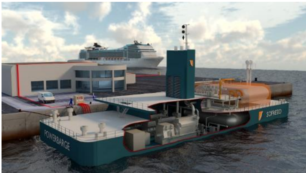
Figure 65- Exemple de phare pour l'alimentation en électricité des navires à quai
