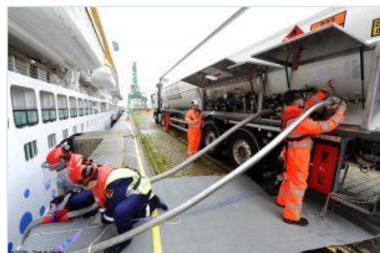
Figure 55 - Ravitaillement en GNL d'un paquebot, mai 2016
