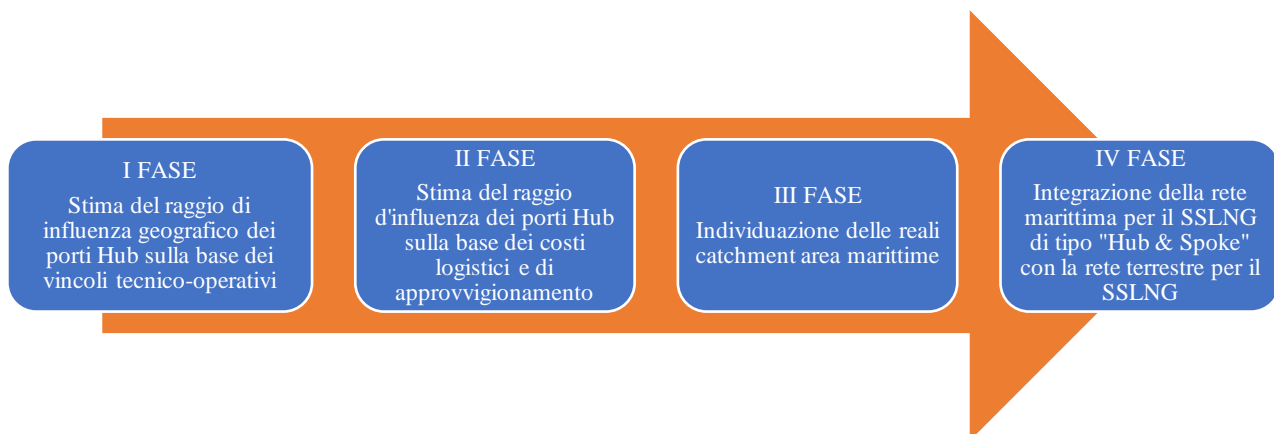
Figura 6. Profili metodologici per la definizione del conceptual framework per la progettazione della rete marittima nazionale per lo SSLNG.
