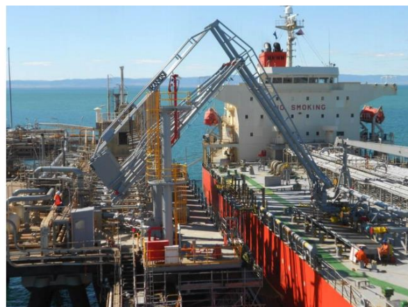
Figura 43: Tipici bracci di carico/scarico del GNL in banchina
