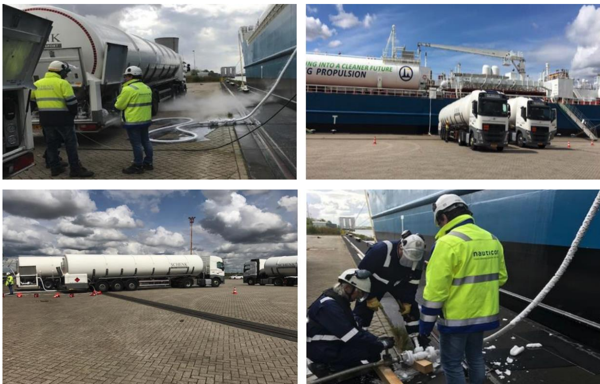
Figura 59: TTS bunkering con connessione multipla della Fure West nel porto di Moerdijk
