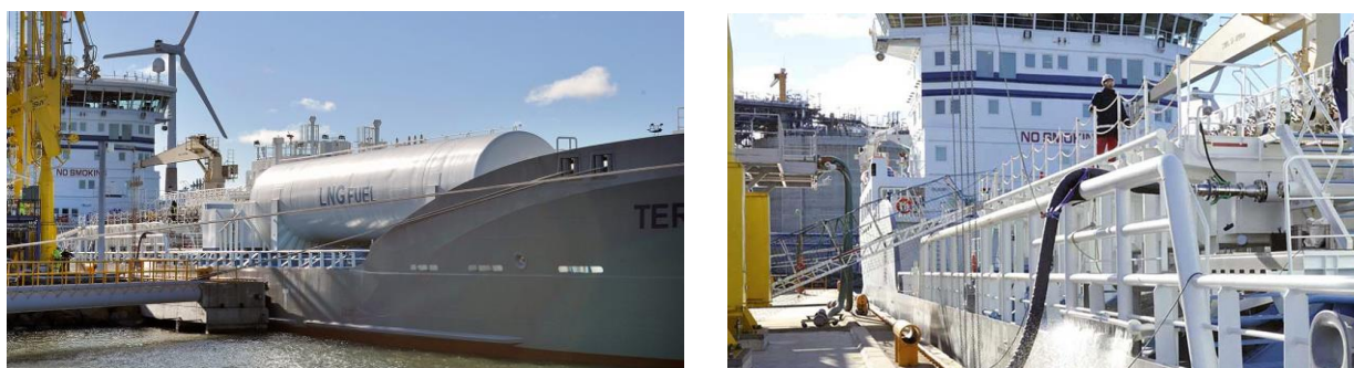
Figura 44: Operazioni di PTS bunkering alla nave Ternsund nel porto di Pori (Finlandia).
