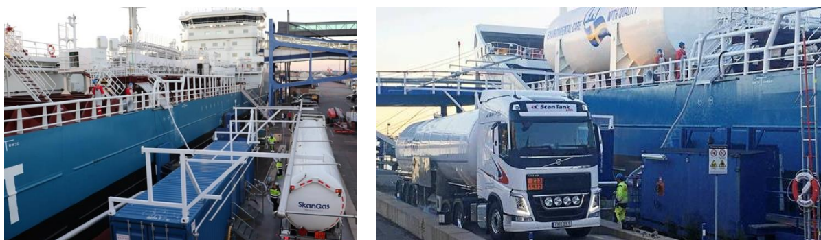
Figura 66: TTS bunkering con Bio-LNG a Fure Vinga nel porto di Goteborg
