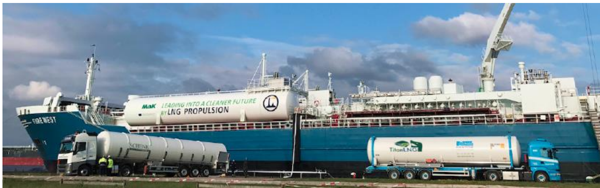
Figura 58: TTS bunkering con connessione multipla della Fure West nel porto di Anversa
