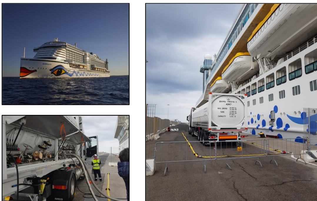
Figura 69: Procedure di TTS bunkering ad AIDA Perla nel porto di Civitavecchia
