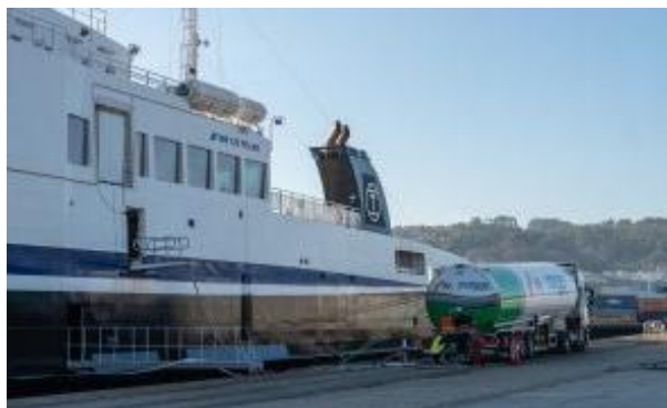
Figura 67: TTS bunkering a Samnøy (sinistra) e Fure Vinga (destra) nei porti di Ferrol e Cartagena
