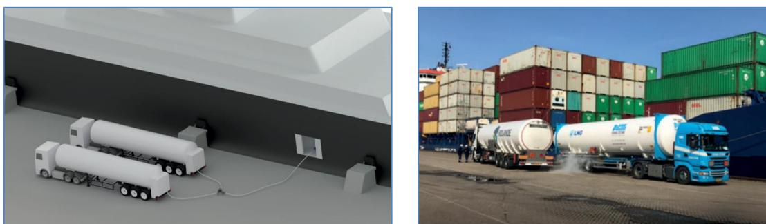
Figura 56: Rendering (sinistra) e operazione reale (destra) del rifornimento simultaneo di due autocisterne utilizzando il componente “Y PIECE” della società Kosan Crisplant
