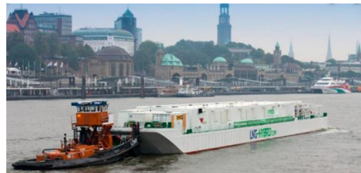
Figura 22: Chiatta di GNL per l'alimentazione elettrica ad Amburgo
