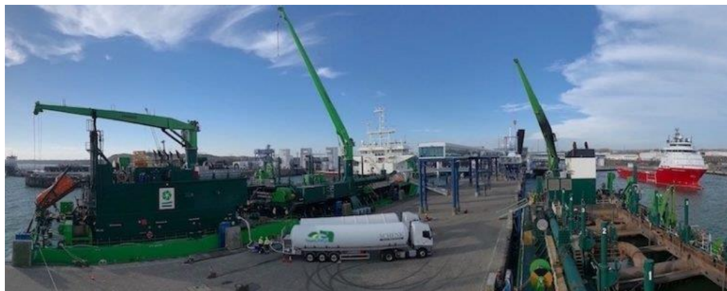
Figura 63: TTS bunkering con connessione multipla nel porto di Mukran
