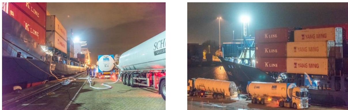
Figura 60: TTS bunkering con connessione multipla nel porto di Rotterdam
