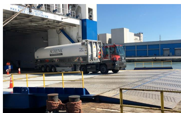
Figura 51: ISO-container con rimorchio in banchina in attesa di essere caricato (sinistra) e scaricato (destra) da nave Ro-Ro durante un'applicazione pilota sulla tratta Barcellona-Livorno
