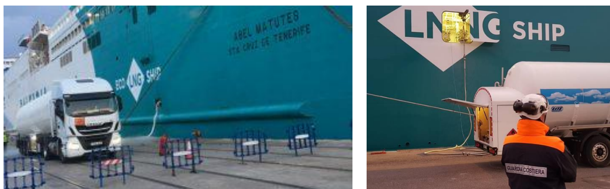
Figura 71: Operazione di rifornimento TTS al traghetto Hypatia de Alejandria nel porto di Venezia
