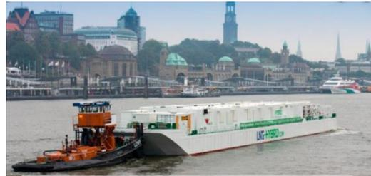
Figure 22 : Barge GNL d'alimentation Electrique à Hambourg
