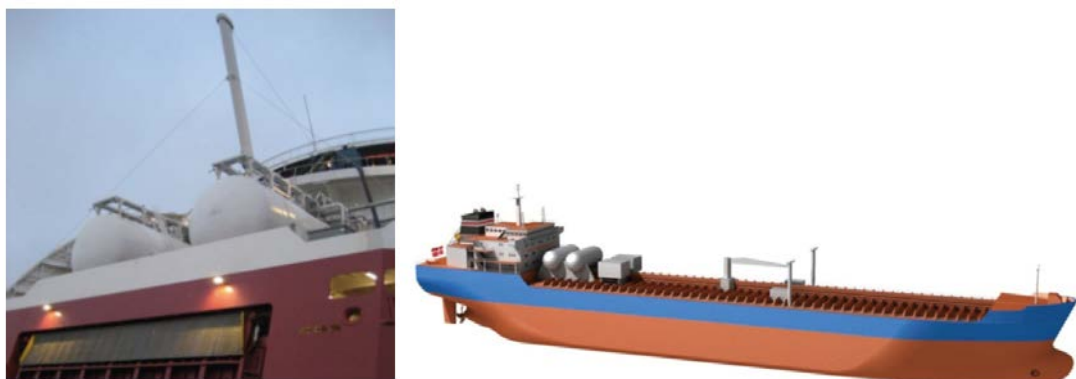
Figura 9 - Serbatoi di tipo C sul ponte di poppa della Viking Grace e sul ponte di prua di una nave cisterna
