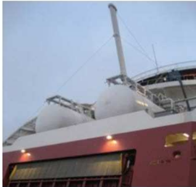
Figure 9 - Réservoirs de type C sur le pont arrière du Viking Grace et sur le pont avant d'un navire-citerne
