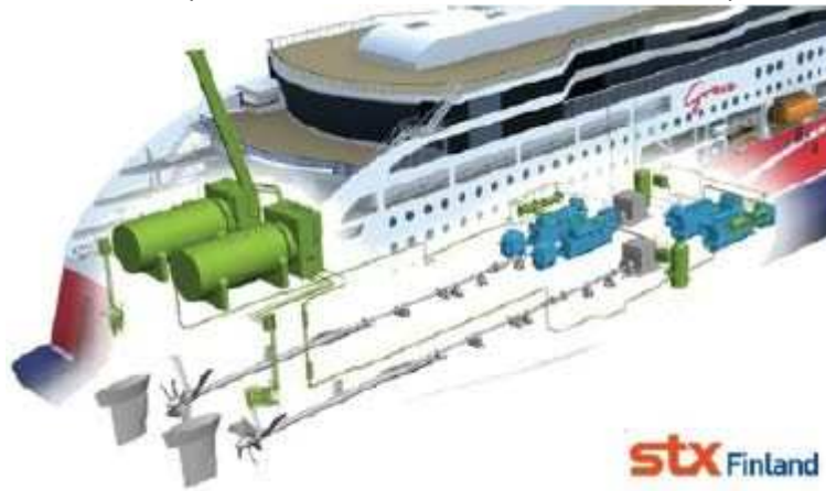
Figure 10 - Schéma du système d'alimentation en gaz de Viking Grace
