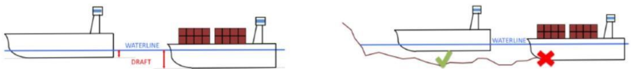
Figure 96 - Limites de tirant d'eau pour les navires entrant dans les ports
