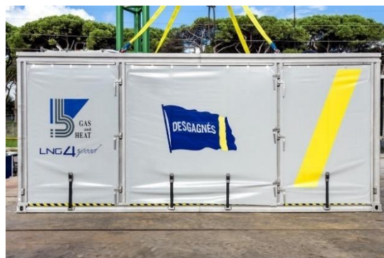
Figura 66 - Operazioni di bunkering in fase di collaudo dello skid (sinistra) e unità riassembleta pronta per il trasporto come container da 20 piedi (destra) di Gas&Heat (Fonte: Gas & Heat)
