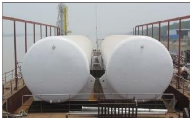
Figura 43 - Due serbatoi di GNL da 250 m 3 installati sul pontone di Baguazhou (Fonte: Jiangsu Haiqiguanghua. CIMC)
