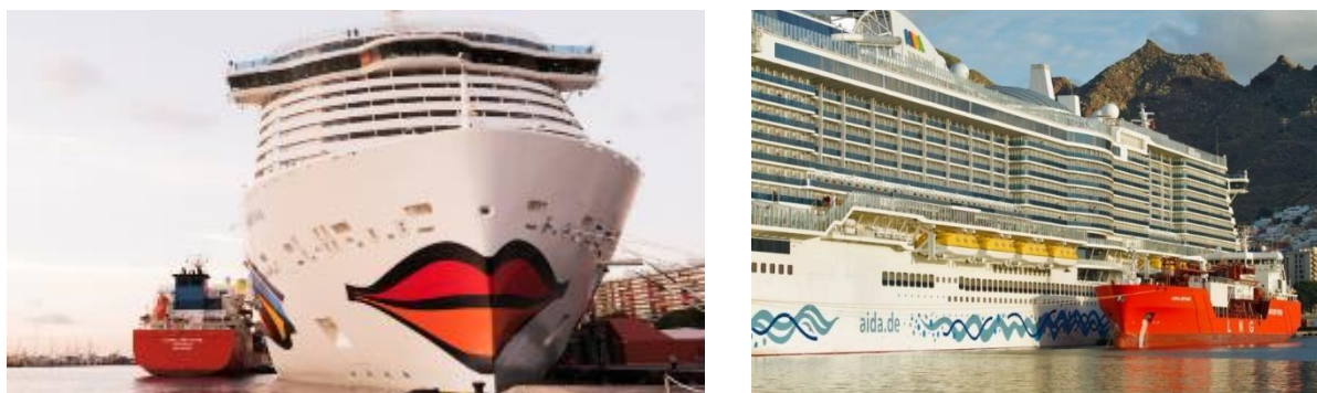
Figura 51 - Operazioni di STS bunkering alla nave AIDA Nova da parte di Coral Methane nel porto di Santa Cruz de Tenerife (Fonte: Conferenza GNL)
