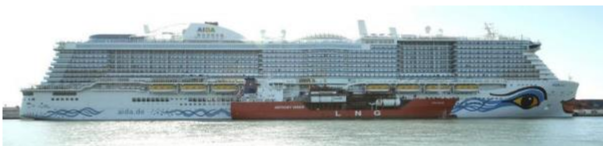
Figura 32 - Sistemi GNL installati a bordo di Aida Nova ed operazioni di rifornimento ship-to-ship (Fonte: Carnival Corp)
