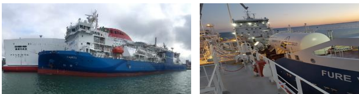
Figura 53 - LBV Kairos nella prima operazione di rifornimento STS al traghetto Visborg nel porto di Visby (Svezia) (Fonte: Wordmaritimenews)
