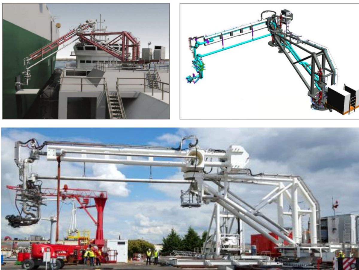
Figura 49 - Rendering e unità realizzata di braccio di carico rigido articolato installabile a bordo nave (Fonte: FMC technologies)
