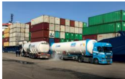
Figura 67 - Rendering (sinistra) e operazione reale (destra) del rifornimento simultaneo di due autocisterne utilizzando il componente “Y PIECE” della società Kosan Crisplant (Fonte: Kosan Crisplant)
