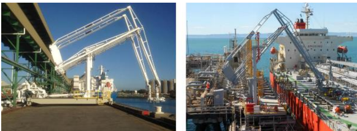
Figura 54 - Tipici bracci di carico/scarico del GNL in banchina (Fonte: Kanon technologies)
