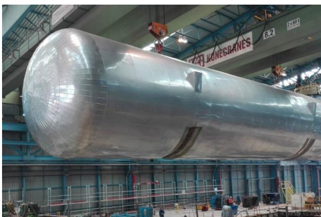
Figura 33 - Serbatoio GNL installato a bordo di Aida Nova (Fonte: http://Intmarine.com )
