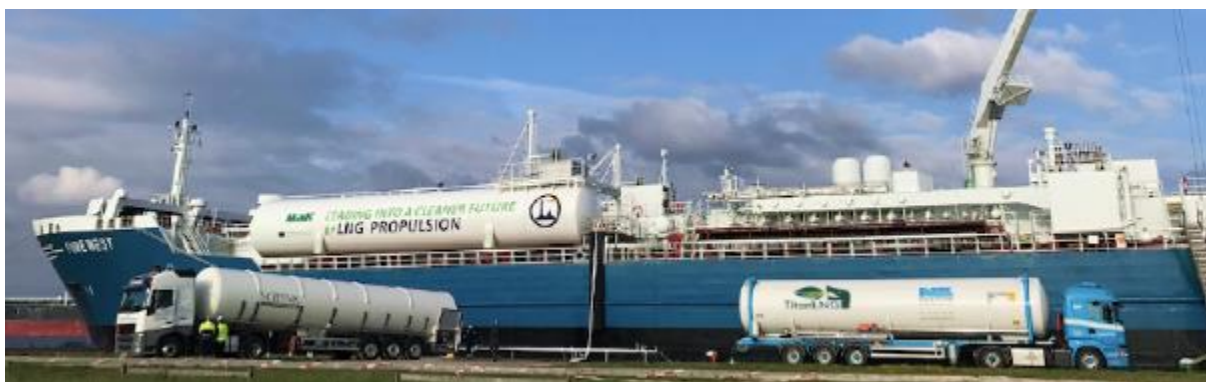
Figura 69 - TTS bunkering con connessione multipla della Fure West nel porto di Anversa (Fonte: Titan LNG)
