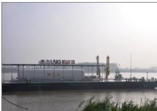
Figura 43 - Due serbatoi di GNL da 250 m 3 installati sul pontone di Baguazhou (Fonte: Jiangsu Haiqiguanghua. CIMC)
