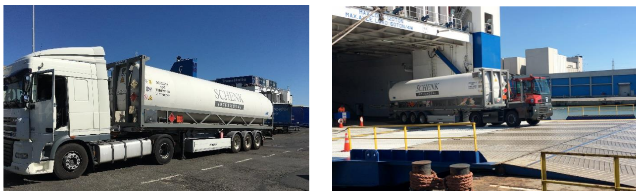
Figura 62 - ISO-container con rimorchio in banchina in attesa di essere caricato (sinistra) e scaricato (destra) da nave Ro-Ro durante un'applicazione pilota sulla tratta Barcellona-Livorno (Progetto GAINN4MED)
