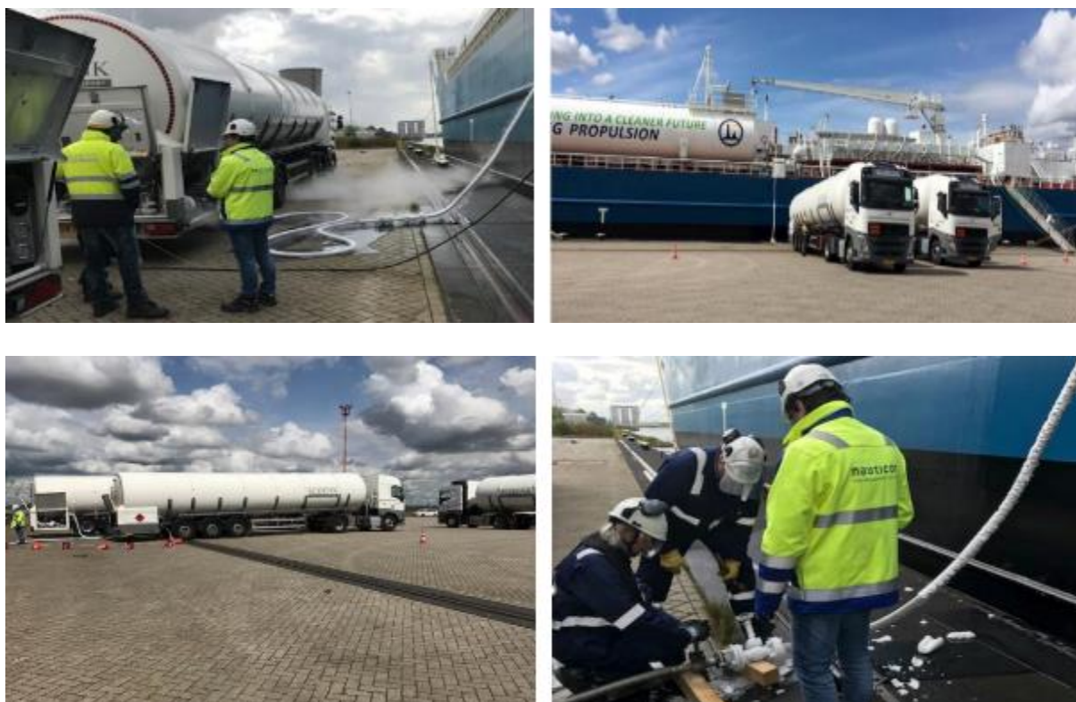
Figura 70 - TTS bunkering con connessione multipla della Fure West nel porto di Moerdijk (Fonte: Nauticor)
