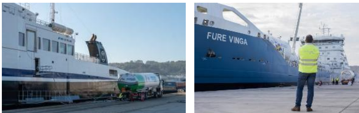
Figura 78 - TTS bunkering a Samnøy (sinistra) e Fure Vinga (destra) nei porti di Ferrol e Cartagena (Fonte: Repsol, Nauticor)
