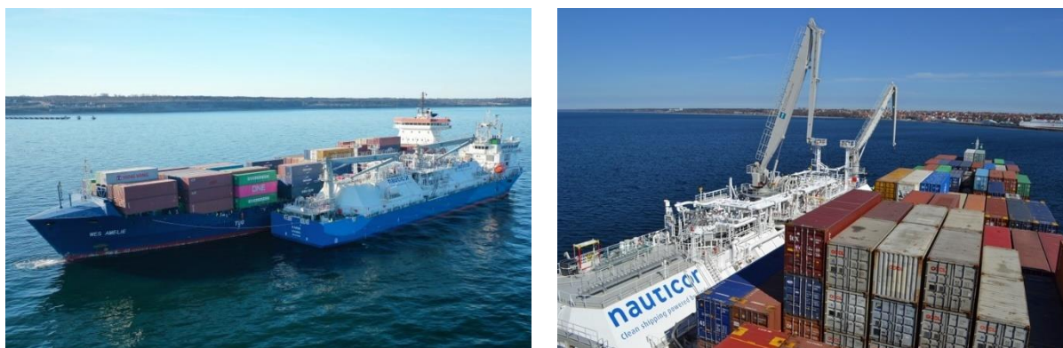
Figura 52 - LBV Kairos nella prima operazione di rifornimento STS alla nave portacontainer Wes Amelie a largo del porto di Amburgo (Fonte: Wordmaritimenews)
