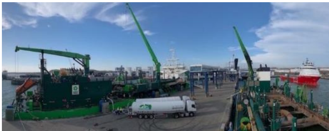
Figura 74 - TTS bunkering con connessione multipla nel porto di Mukran (Fonte: Titan LNG)
