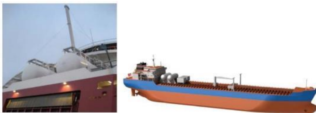
Figura 37- Serbatoi di tipo C sul ponte di poppa della Viking Grace e sul ponte di prua di una nave cisterna
