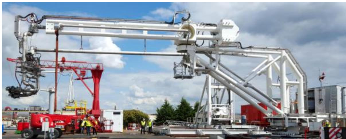
Figure 49 - Rendu et unité réalisée du bras de chargement rigide articulé pouvant être installé à bord d'un navire (Source: FMC technologies)
