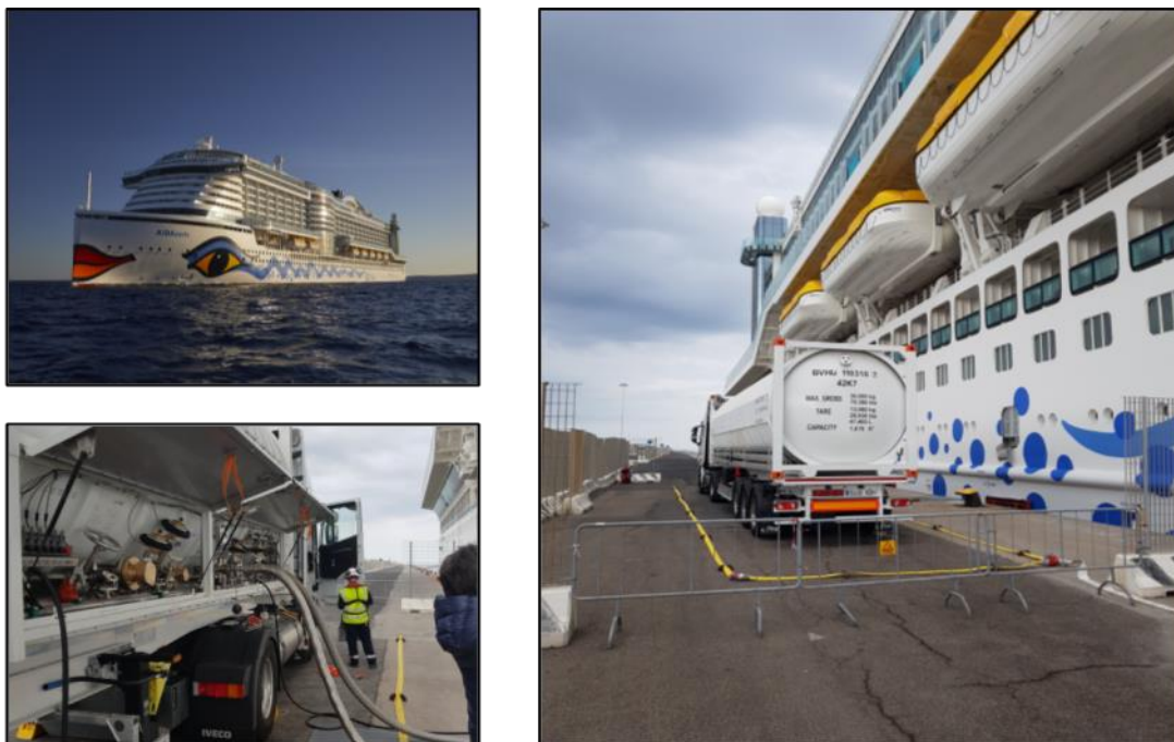
Figure 80 - Procédure de soutage de TTS pour AIDA Perla dans le port de Civitavecchia (Source: Projet GAINN4MOS)
