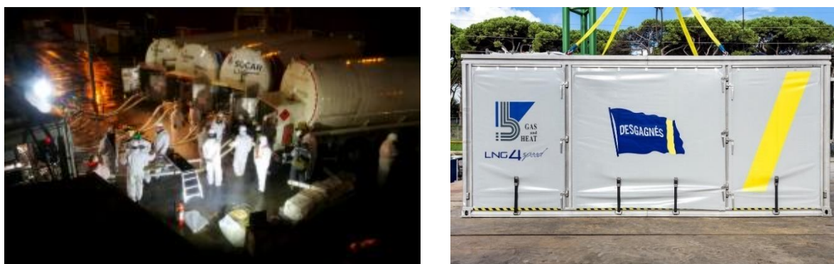
Figure 66 - Opérations d'avitaillement pendant l'essai des patins (à gauche) et unité réassemblée prête à être transportée sous forme de conteneur de 20 pieds (à droite) par Gas&Heat (Source: Gas & Heat)
