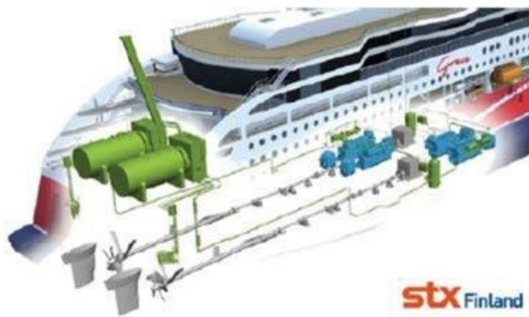
Figure 38 - Structure du système de gaz combustible Viking Grace
