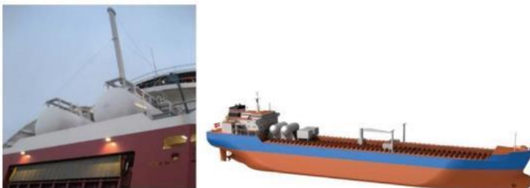
Figure 37 - Citernes de type C sur le pont arrière du Viking Grace et sur le pont avant d'un pétrolier
