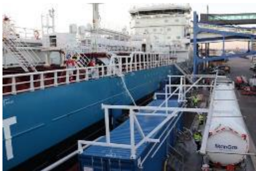
Figure 77 - Avitaillement TTS avec du Bio-LNG à Fure Vinga dans le port de Göteborg (Source: NGV)
