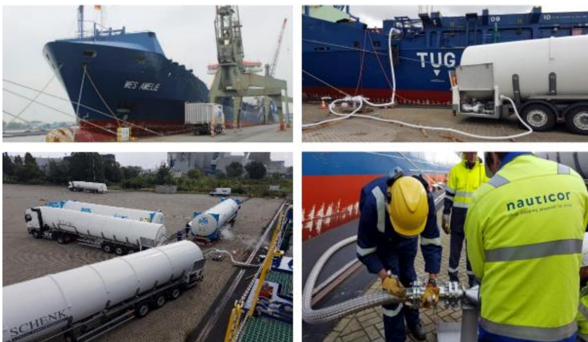
Figure 73 - Avitaillement TTS avec connexion multiple du porte-conteneurs Wes Amelie dans le port de Bremerhaven (Source: Nauticor)
