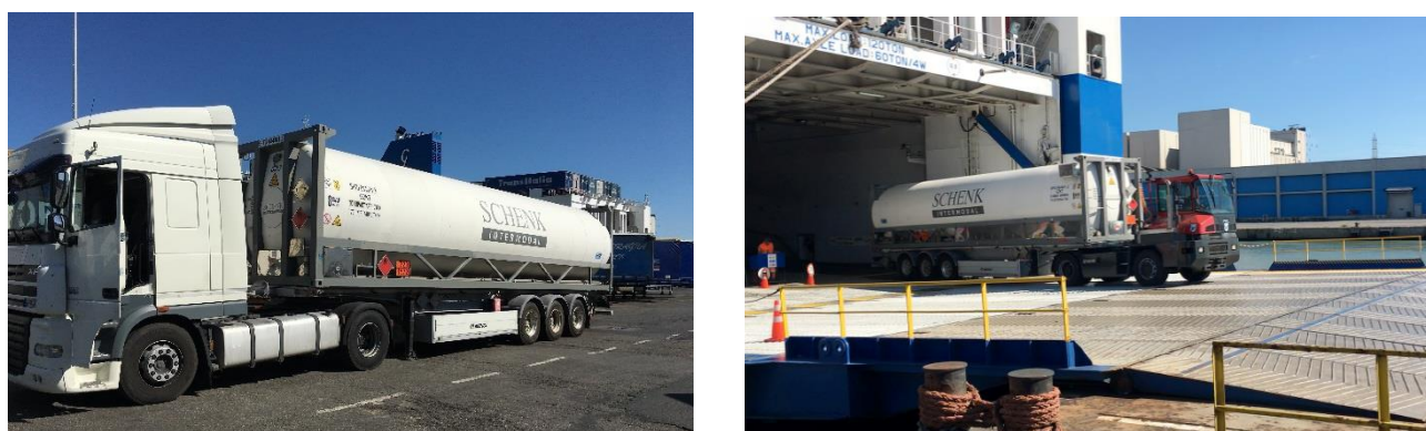
Figure 62 - Conteneur ISO avec remorque sur le quai attendant d'être chargé (à gauche) et déchargé (à droite) par un navire Ro-Ro lors d'une application pilote sur la route Barcelone-Livourne (Projet GAINN4MED)
