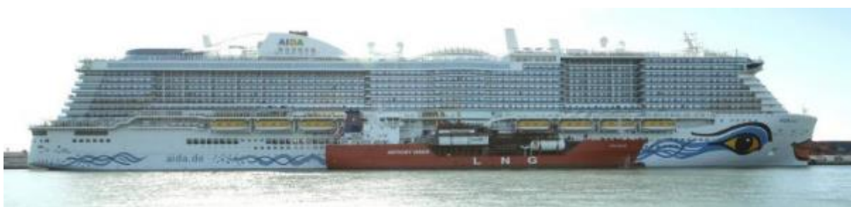
Figure 32 - Systèmes GNL installés à bord de l'Aida Nova et opérations de ravitaillement de navire à navire (Source: Carnival Corp)
