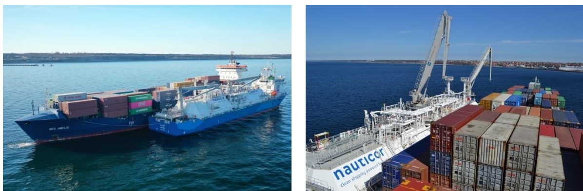
Figure 52 - Le LBV Kairos lors de la première opération d'approvisionnement STS du porte-conteneurs Wes Amelie au large du port de Hambourg (Source: WordmaritimeneWS)
