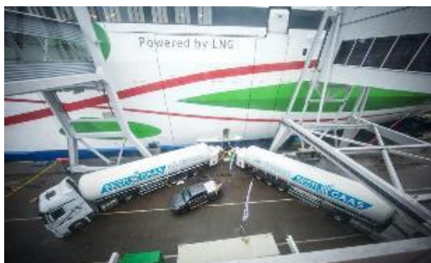
Figure 75 - Avitaillement de TTS avec connexion multiple au ferry Megastar dans le port de Tallinn (Source: Eesti Gaas)
