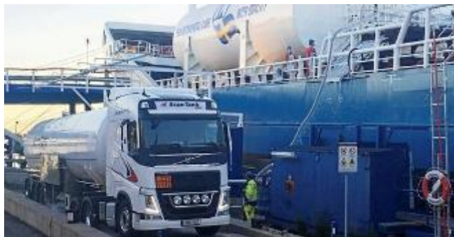
Figure 77 - Avitaillement TTS avec du Bio-LNG à Fure Vinga dans le port de Göteborg (Source: NGV)
