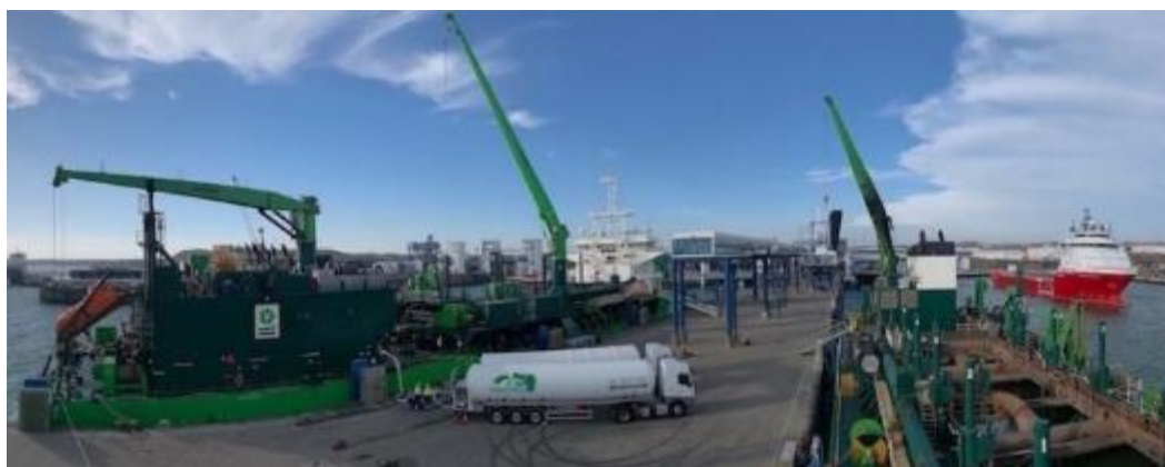
Figure 74 - Avitaillement TTS avec connexion multiple dans le port de Mukran (Source: Titan LNG)
