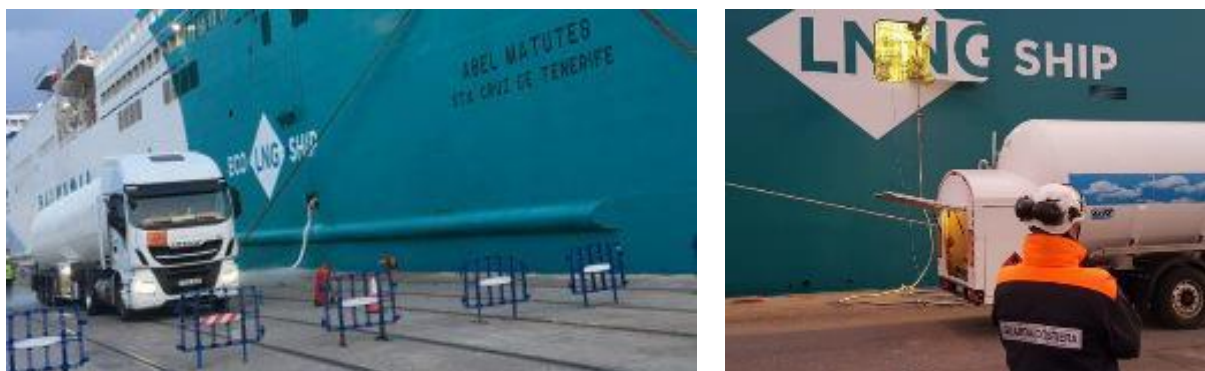
Figure 82 - Opération de ravitaillement en TTS sur le ferry Hypatia de Alejandria dans le port de Venise (Source: Worldmaritime news, ANSA)
