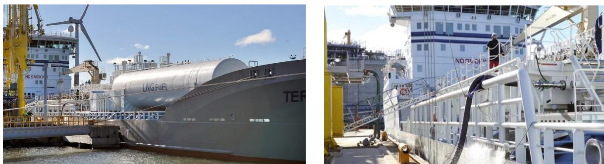
Figure 55 - Opérations de ravitaillement en STP du navire Ternsund dans le port de Pori (Finlande) (Source: Mann Tek)
