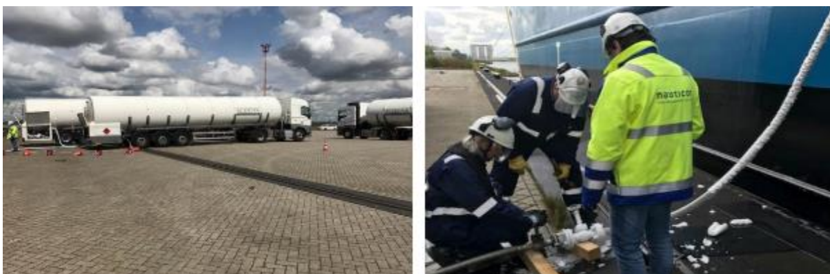
Figure 70 - Avitaillement TTS avec connexion multiple du Fure West dans le port de Moerdijk (Source: Nauticor)
