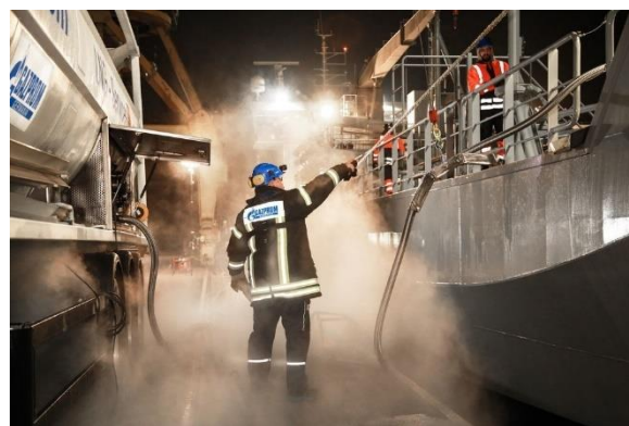
Figure 72 - Avitaillement TTS à la cimenterie M.V. Greenland dans le port de Rostock (Source: Gazprom)
