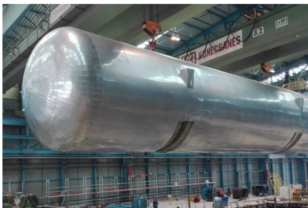
Figure 33 - Réservoir de GNL installé à bord de l'Aida Nova (Source : http://Intmarine.com )
