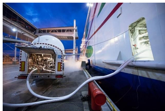
Figure 75 - Avitaillement de TTS avec connexion multiple au ferry Megastar dans le port de Tallinn (Source: Eesti Gaas)
