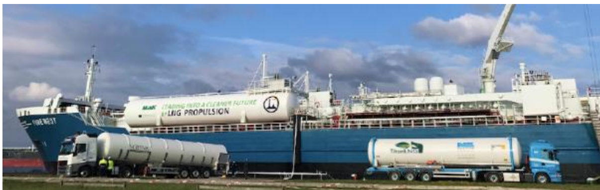
Figure 69 - Avitaillement TTS avec connexion multiple du Fure West dans le port d'Anvers (Source: Titan LNG)
