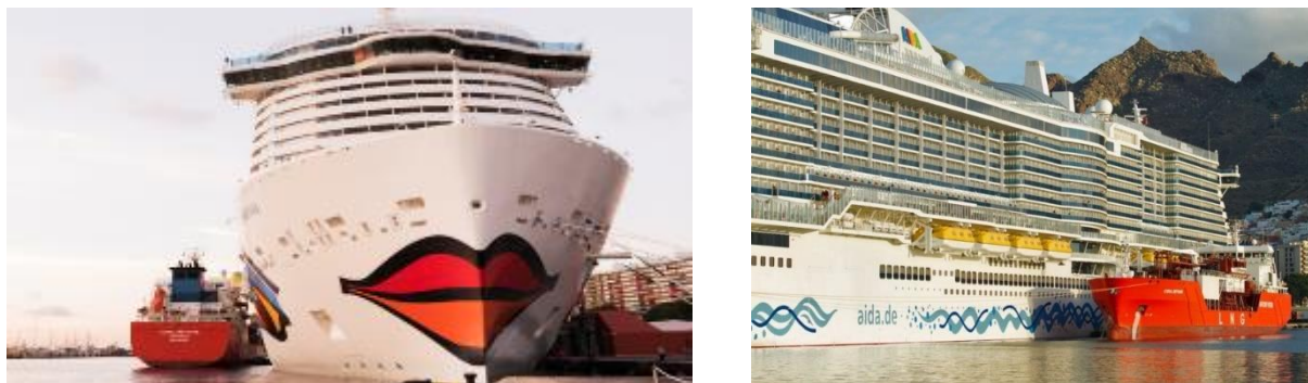
Figure 51 - Opérations de soutage STS du navire AIDA Nova par Coral Methane dans le port de Santa Cruz de Tenerife (Source: LNG Conference)
