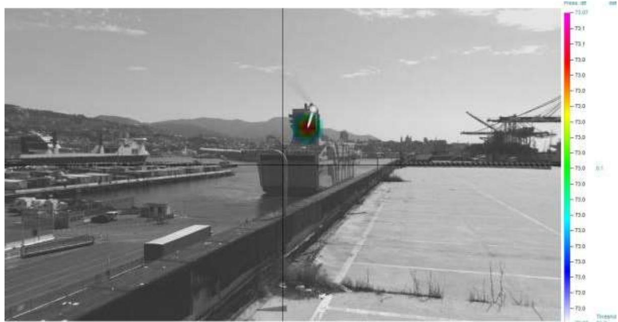
Figure 2.a. Image source antenne acoustique. Arrivé GNV Splendid. fréquence d'analyse: 66 Hz -13 kHz
