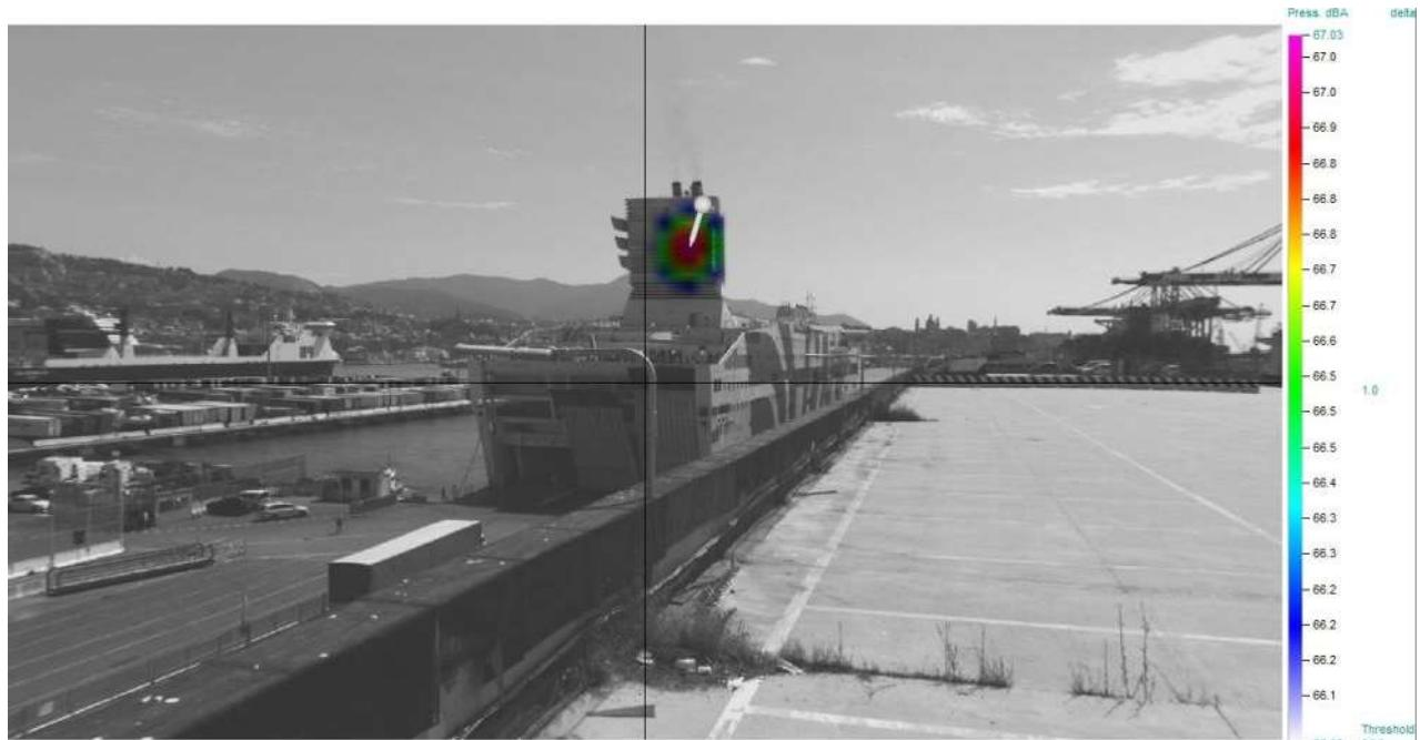
Figura 2.a. Immagine sorgente acoustic camera. Arrivo GNV Splendid sorgente. Range frequenza di analisi: 66 Hz -13 kHz
