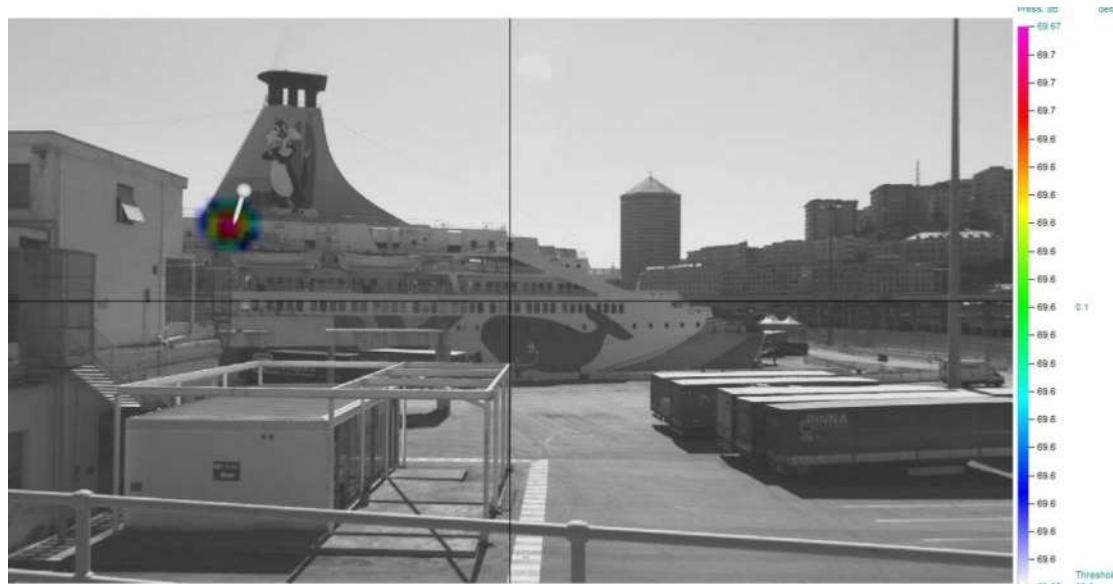
**Figura 2. Immagine sorgente acoustic camera. Sorgente ventilazione MOBY DREA. Range frequenza di analisi: 66 Hz -13 kHz**
