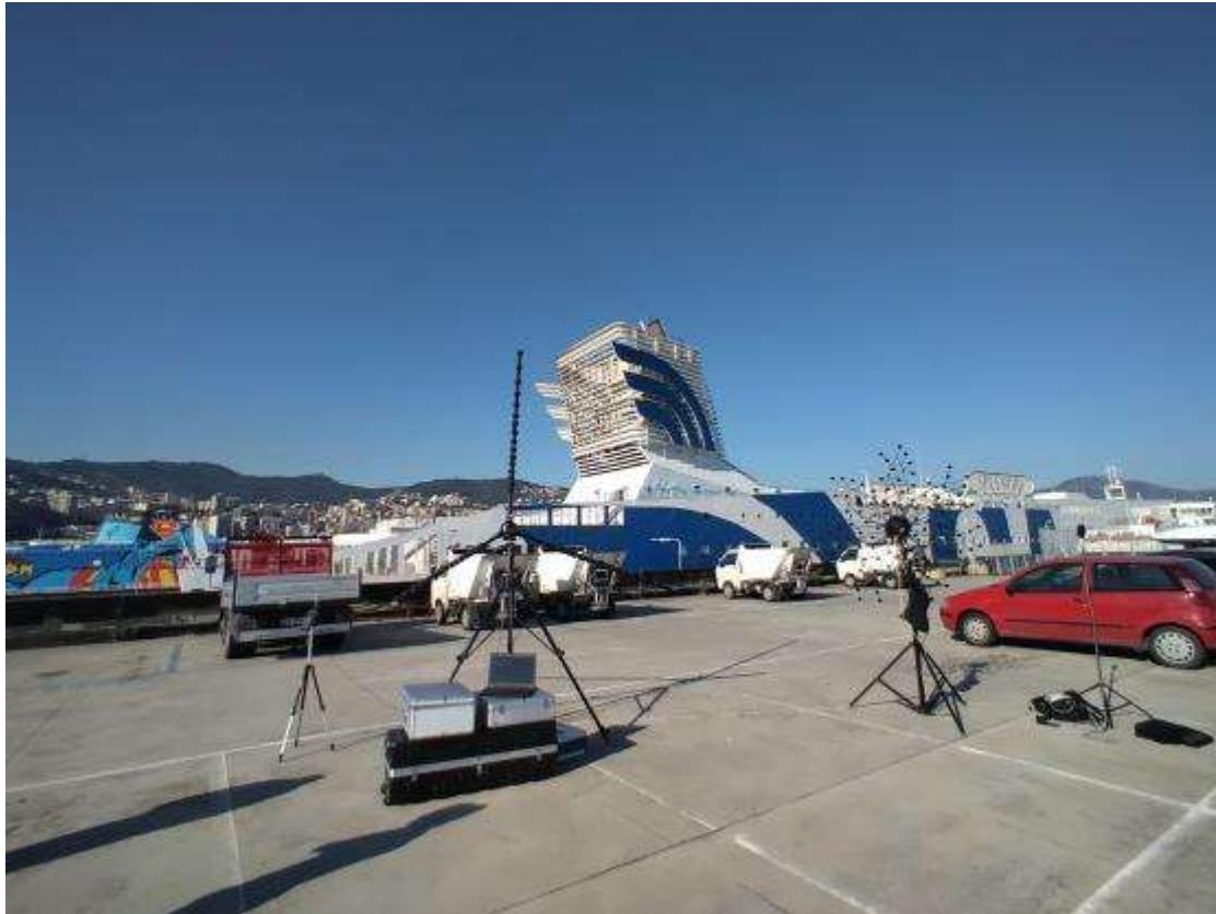
**Figure 1. Mesure 2.3Antenne acoustique et sonomètre.**
