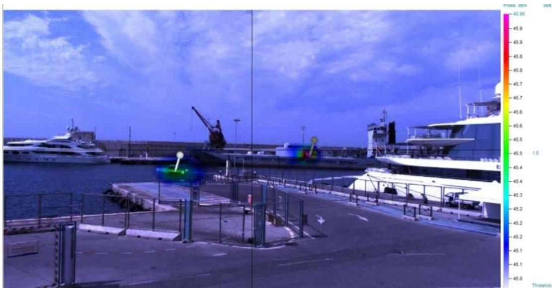
Figura 2.b. Immagine sorgente acoustic camera. Yatch e carica nave. Range frequenza di analisi: 66 Hz -13 kHz
