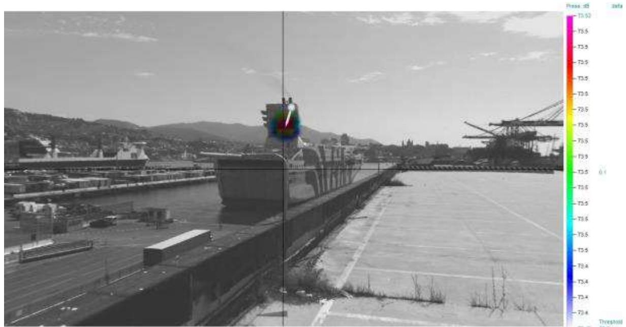
Figure 2.b. Image source antenne acoustique. Arrivé GNV Splendid. fréquence d'analyse: 66 Hz -13 kHz
