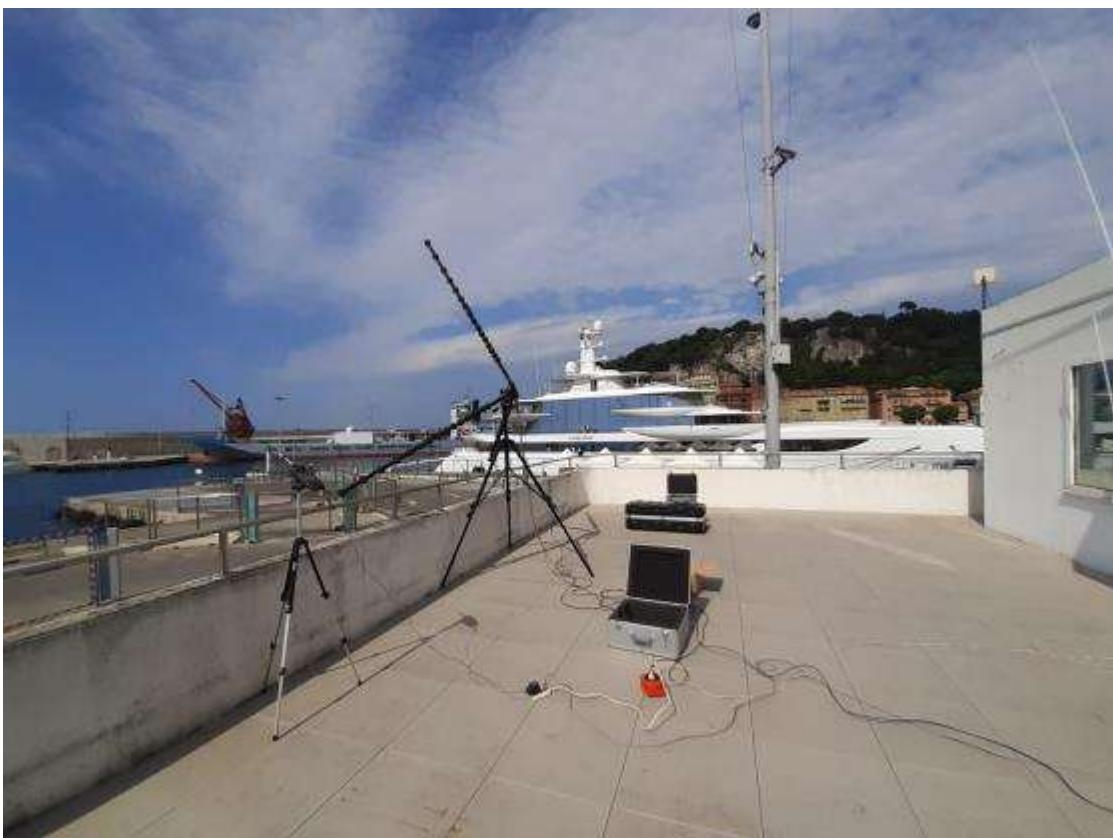
**Figure A. Mesure 3.4, Antenne acoustique et sonomètre.**
