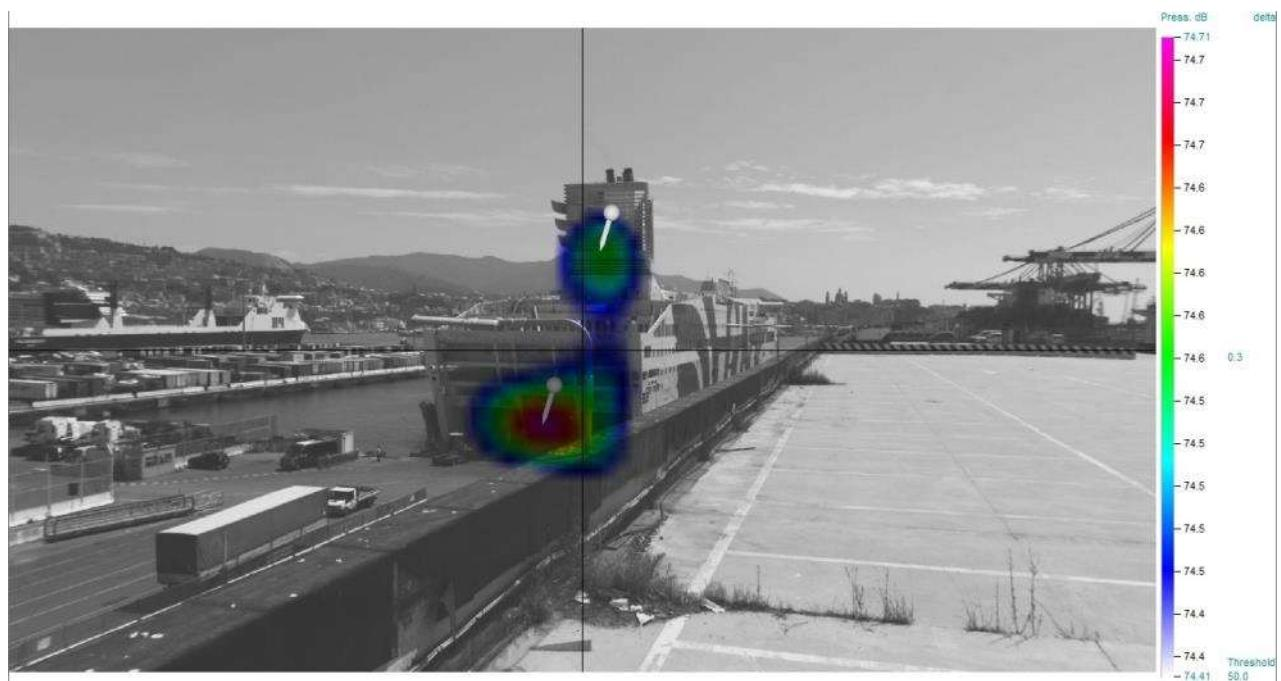
Figura 2.b. Immagine sorgente, acoustic camera. Arrivo GNV Splendid inizio scarico. Range frequenza di analisi: 66 Hz -13 kHz
