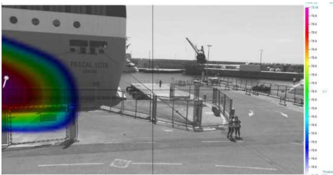
Figure 2. Image source antenne acoustique. Fermeture moteur. intervalle fréquence di analisi: 66 Hz -13 kHz.
