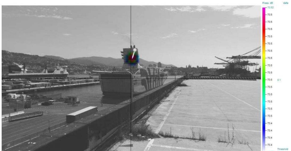
**Figura 2.b. Immagine sorgente, acoustic camera. Arrivo GNV Splendid. Range frequenza di analisi: 66 Hz -13 Hz**
