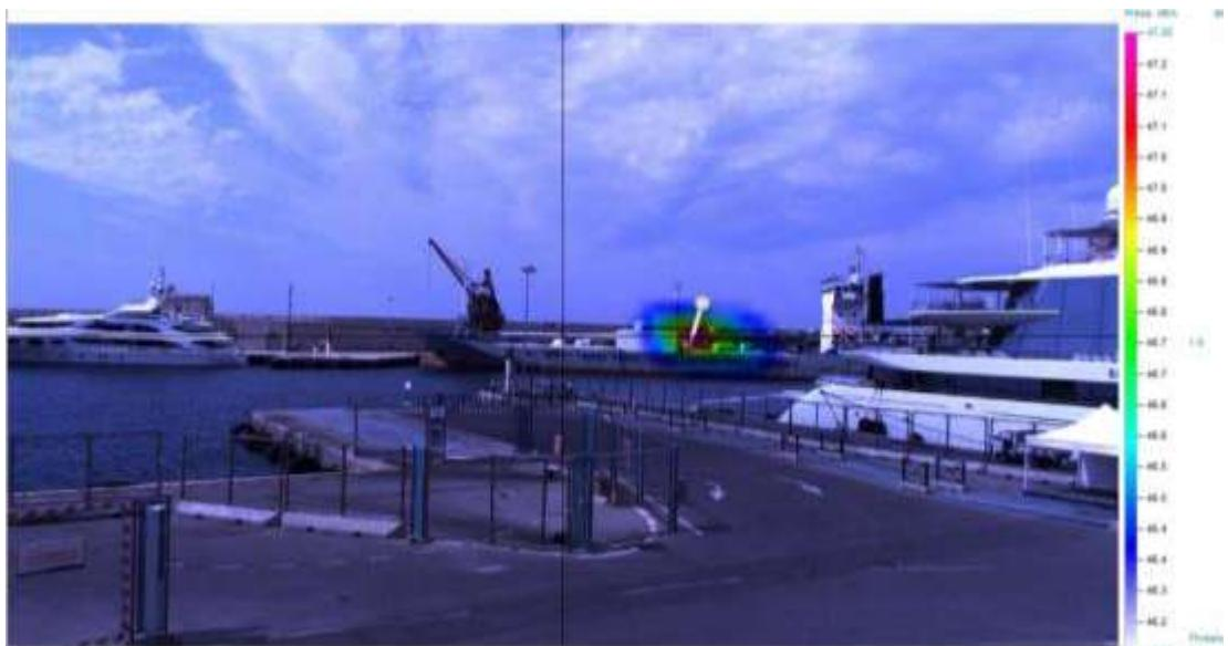
Figure 2.a. Image source antenne acoustique. Chargement navire. fréquence d'analyse: 66 Hz -13 kHz
