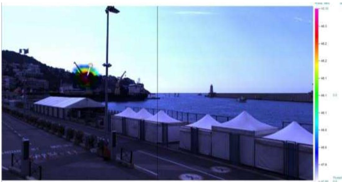
**Figure 2. Image source antenne acoustique. Soundscape porto Nizza. Intervalle de fréquence d'analyse: 66 Hz -13 kHz**
