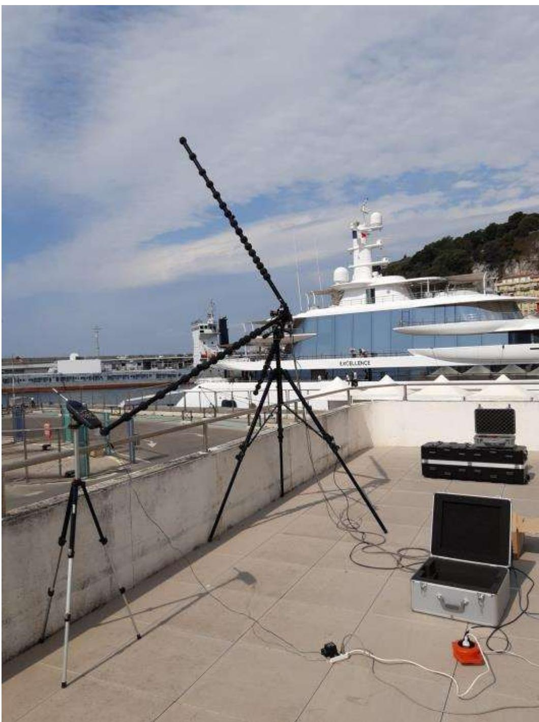
**Figure A. Mesure 3.1 Antenne acoustique et sonomètre.**
