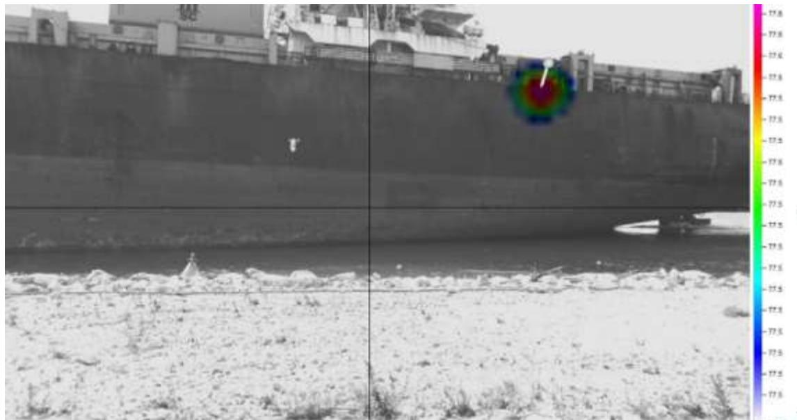
Figure 2.b. Image source antenne acoustique. MSC Maria Pia, Ventilation fréquence d'analyse: 66 Hz -13 kHz
