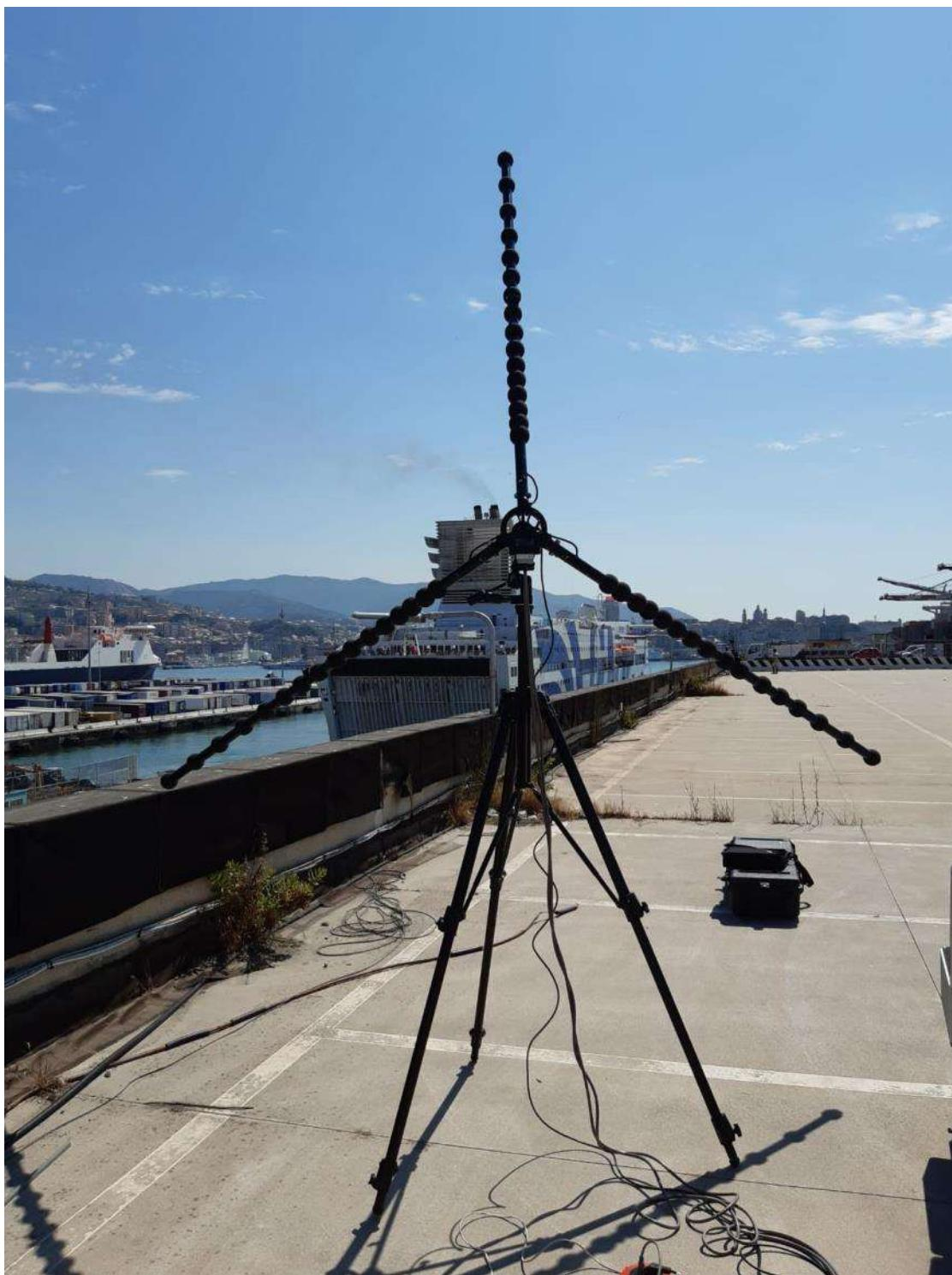
**Figura A. Misura 2.1 Acoustic camera e fonometro.**
