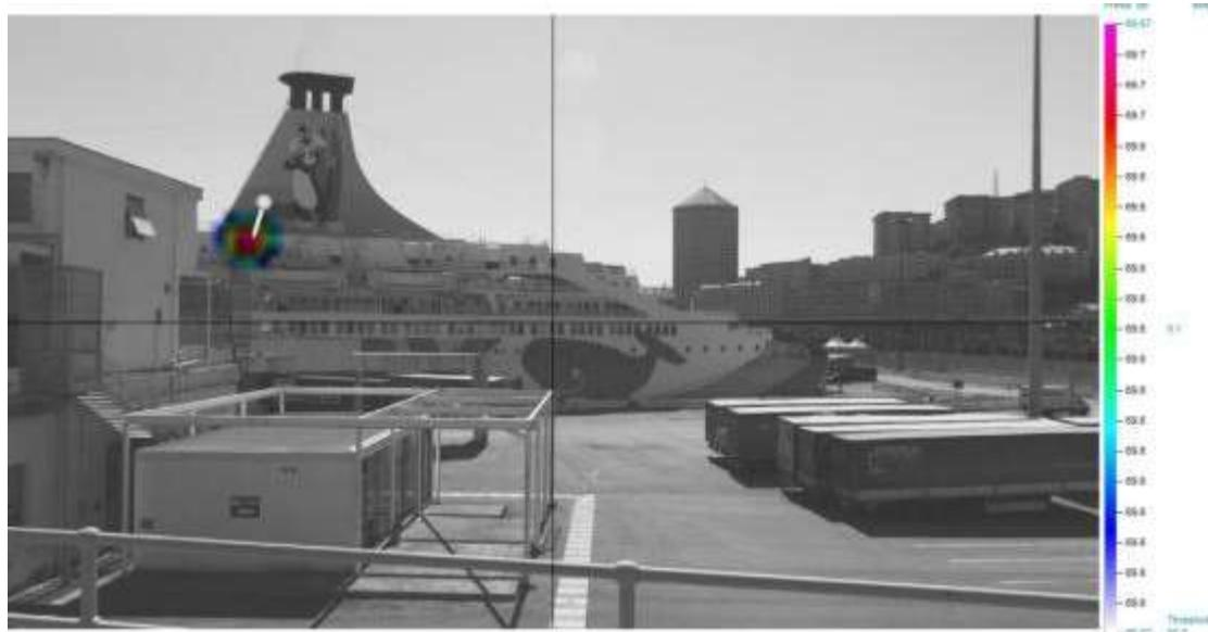
Figure 2. Image source antenne acoustique. Source ventilation Moby Drea. fréquence d'analyse: 66 Hz -13 kHz
