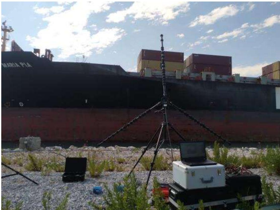
**FigureA. Mesure 1.1, Antenne acoustique.**
