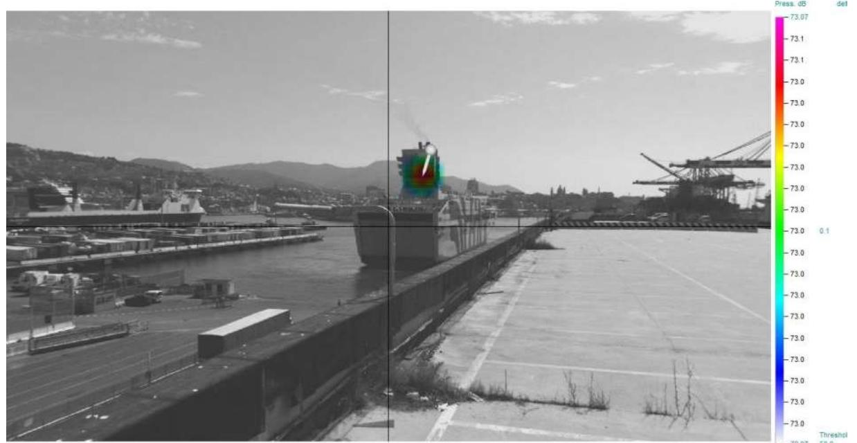
**Figura 2.a. Immagine sorgente acoustic camera. Arrivo GNV Splendid. Range frequenza di analisi: 66 Hz - 13 kHz**
