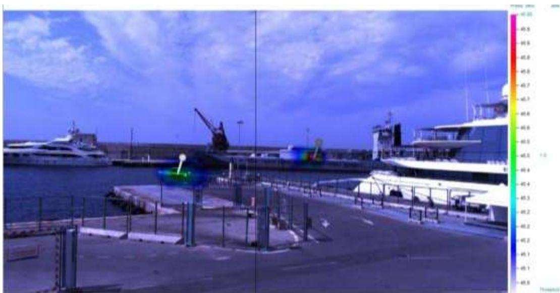
Figure 2.b. Image source antenne acoustique. Yatch et chargement navire. fréquence d'analyse: 66 Hz -13 kHz
