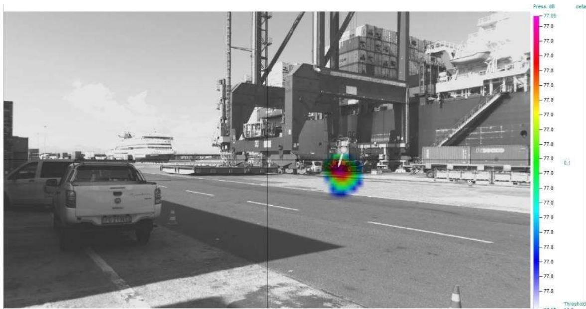
Figura 2.b. Immagine sorgente, acoustic camera. Gru. Range frequenza di analisi: 66 Hz -13 kHz
