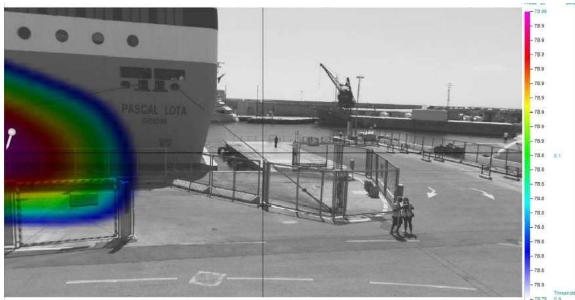
**Figura 2. Immagine sorgente acoustic camera. Chiusura, sorgenti motori ausiliari. Range frequenza di analisi: 66 Hz -13 kHz.**
