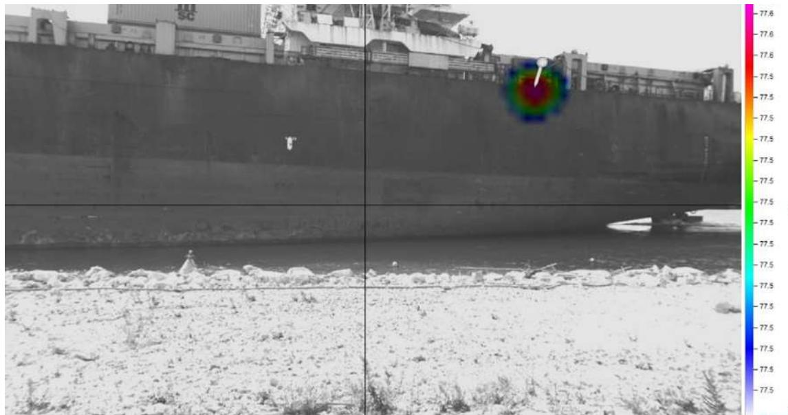
**Figura 2.b. Immagine sorgente, acoustic camera. MSC Maria Pia ventilazione. Range frequenza di analisi: 66 Hz -13 Hz**
