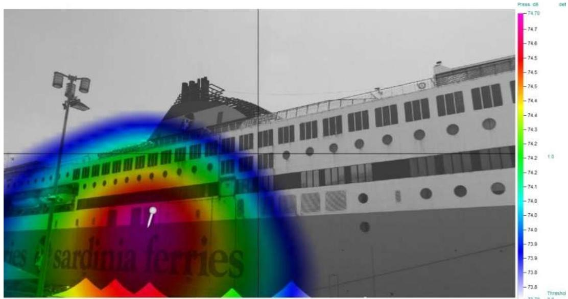
**Figura 2a.** Immagine sorgente acoustic camera. Stazionamento Pascal Lota sorgente ventilazione. Range frequenza di analisi: 66 Hz -13 kHz.
