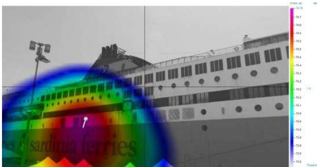
Figure 2a. Image source antenne acoustique. Ventilation Pascal Lota. intervalle fréquence di analisi: 66 Hz -13 kHz.
