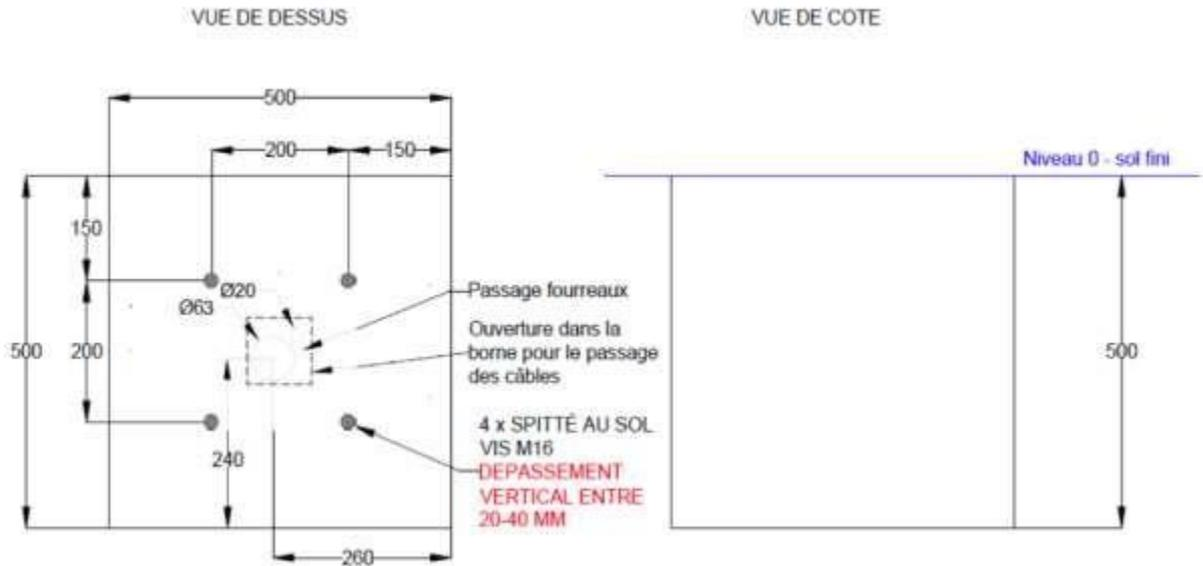
Image 8: Plan du massif de fondation de la borne Kino® PRO (vue de dessus, dimensions en mm)
