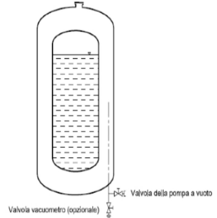
Dispositivo di sfogo del recipiente esterno (dispositivo di sfogo della sovrappressione)
