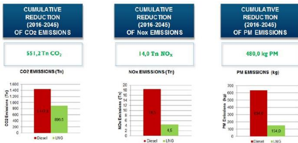
Figura 20: Risultati dell'abbattimento di CO 2 , NO x e PM nel caso studio del porto di Tarragona
