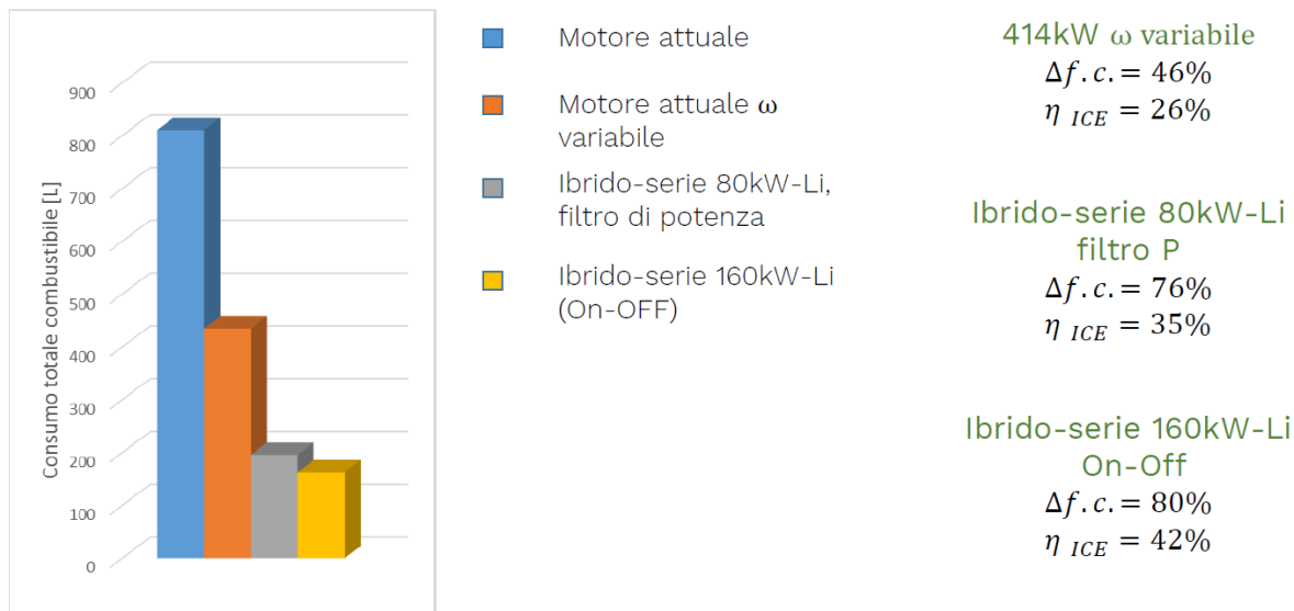
Figura 15: Riduzione dei consumi di combustibile per le RTG nelle varie configurazioni simulate
