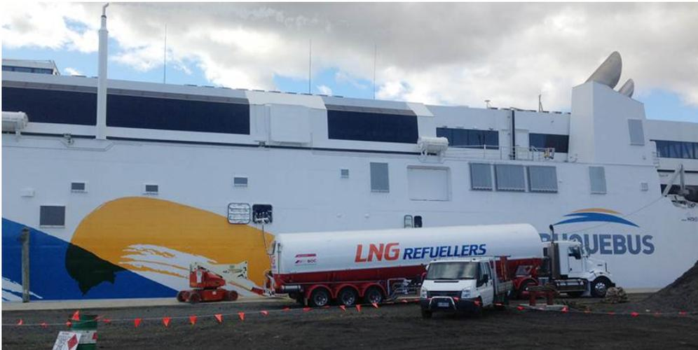
**Figura 4 - Esempio di bunkeraggio TTS diretto su traghetto veloce (porto di Buenos Aires)**
