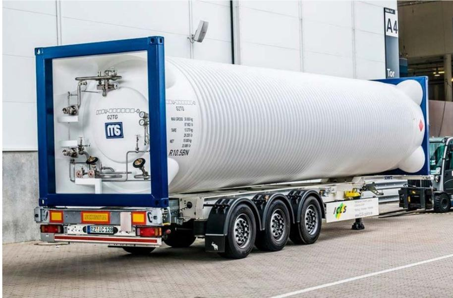
**Figura 6 - Serbatoio di GNL containerizzato**
