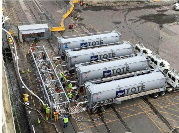
**Figura 5 - Esempio di bunkeraggio TTS indiretto su navi portacontainer (porto di Jacksonville, Stati Uniti)**
