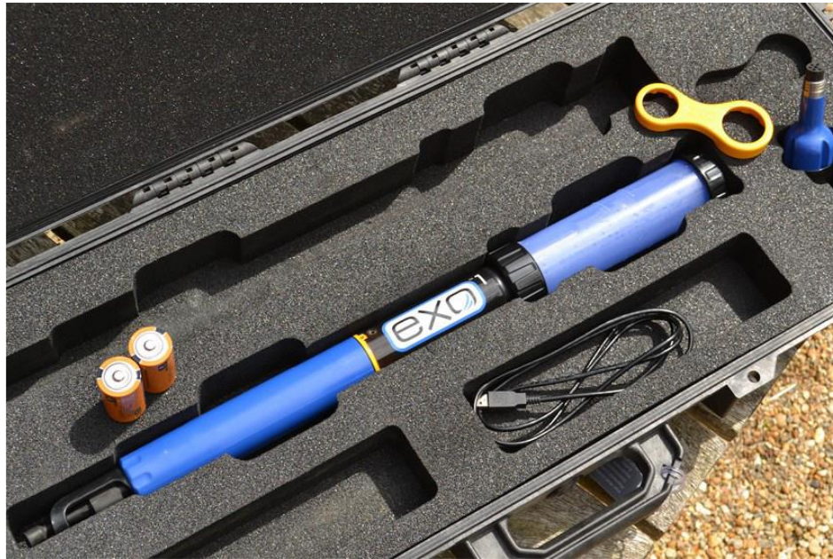
Figure 4 – La sonde EXO multi-paramètres
