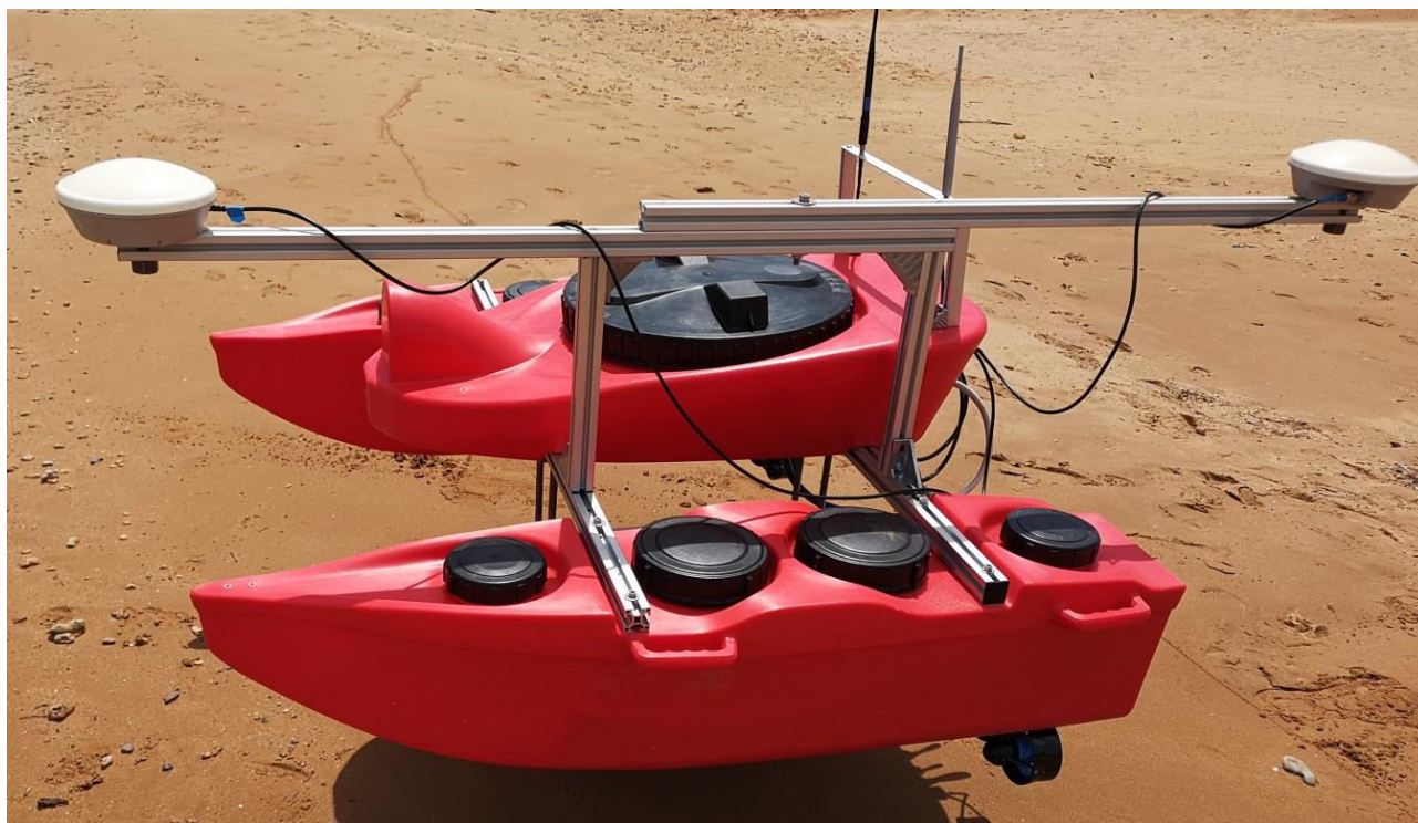
Figura 2 - Il veicolo autonomo della classe SWAP utilizzato nel rilievo
