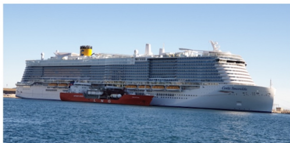
Ravitaillement du navire Costa Smeralda à La Spezia avec barge
