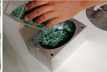
4) Disposizione delle chips nello stampo
