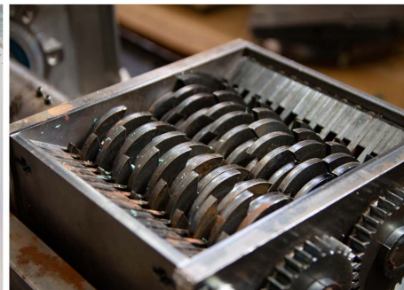
4) Seconda lavorazione: riduzione della lastra in chips
