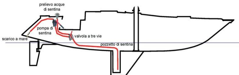
**Fig. 8 - Schéma d'installation des kits pour l'adaptation de bateaux existants équipés d'une pompe de cale des eaux grises**
