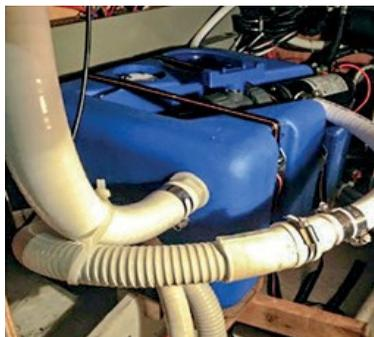
**Fig. 7 - Détail d'un kit de récupération des eaux usées avec raccordement standard au système de collecte et d'aspiration (Source Giornale della Vela- Panama Editore)**
