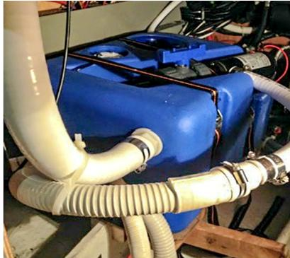
Fig. 7 – Détail d'un kit de récupération des eaux usées avec raccordement standard au système de collecte et d'aspiration.
