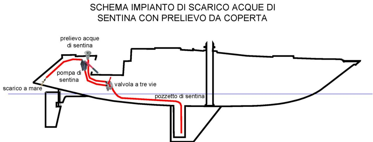
Fig. 8 – Schéma d'installation des kits pour l'adaptation de bateaux existants équipés d'une pompe de cale des eaux grises.
