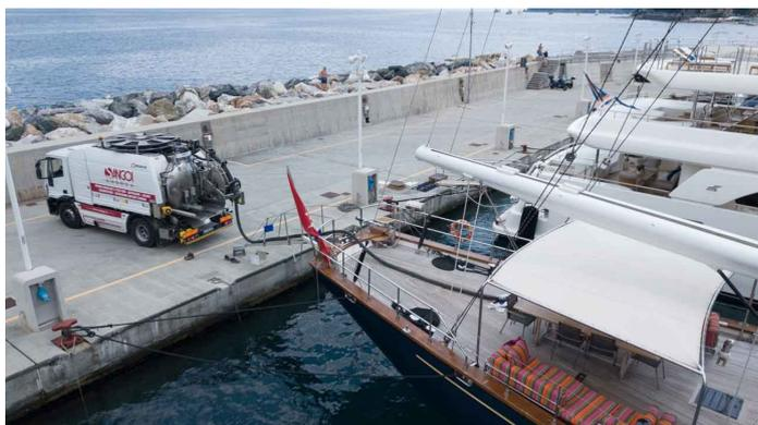
Fig. 2 – Opération de déchargement des déchets d'un yacht à travers un véhicule terrestre
