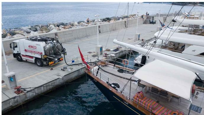
Fig. 2 – Operazione di scarico dei reflui da uno yacht attraverso un mezzo terrestre (Fonte: web site <https://www.sangoi.it/spurgo-yacht-e-imbarcazioni/>)
