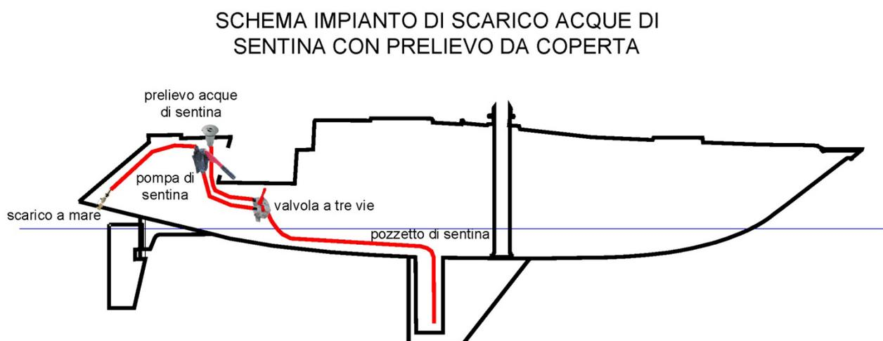
Fig. 8 - Schema di installazione di kit per l'adeguamento delle imbarcazioni esistenti dotate di pozzetto di sentina delle acque grigie
