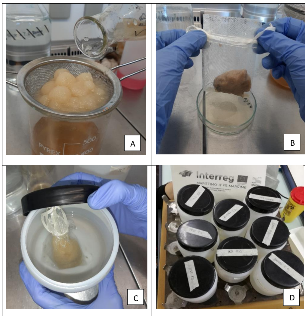
Figura 2.2.1 A) Filtraggio dei pellets fungini ed eliminazione del brodo di coltura in eccesso; B) allestimento di sacchetti microporosi contenenti biomassa fungina; C) immersione dei sacchetti in bottiglie contenenti acqua marina contaminata e non; D) mantenimento delle bottiglie in agitazione per 15 giorni.
