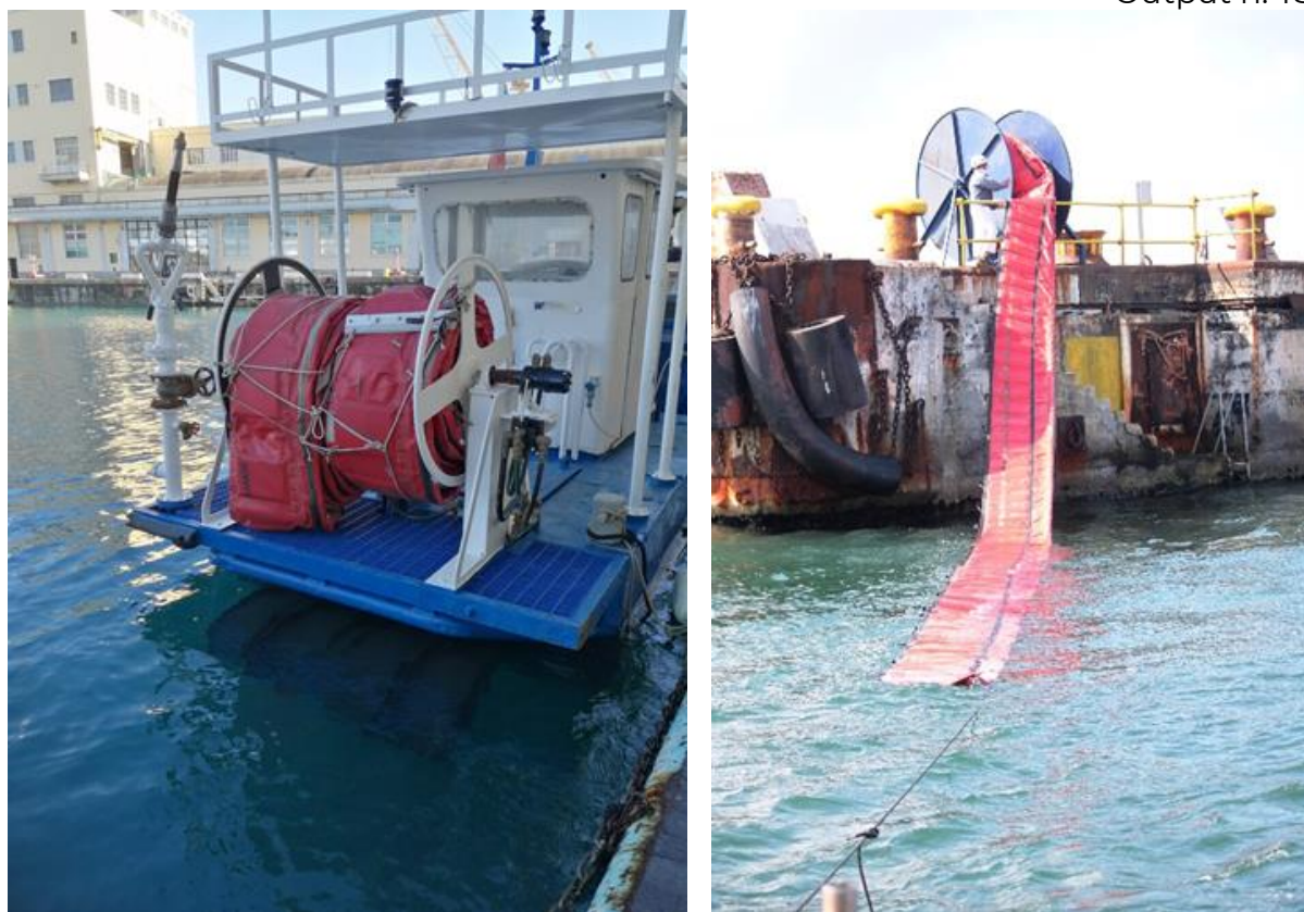
Fig. 3.2 Barrages installés sur un navire (à gauche) et déployés sur des rouleaux sur un quai de port (à droite).
