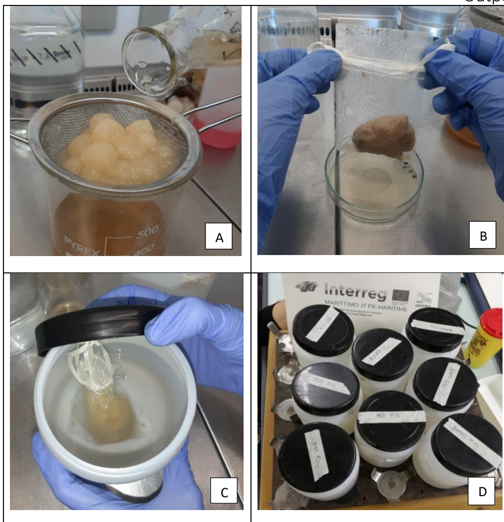
Fig. 2.2.1 A) Filtration des granulés fongiques et élimination de l'excès de bouillon de culture ; B) préparation de sacs microporeux contenant la biomasse fongique ; C) immersion des sacs dans des bouteilles contenant de l'eau de mer contaminée et non contaminée ; D) maintien des bouteilles sous agitation pendant 15 jours.
