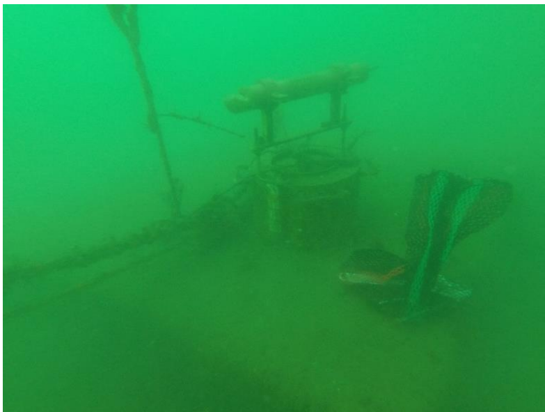
Fig. 2. Il corpo morto posizionato a mare con lo strumento montato / Le corps mort positionné en mer avec l'instrument monté
