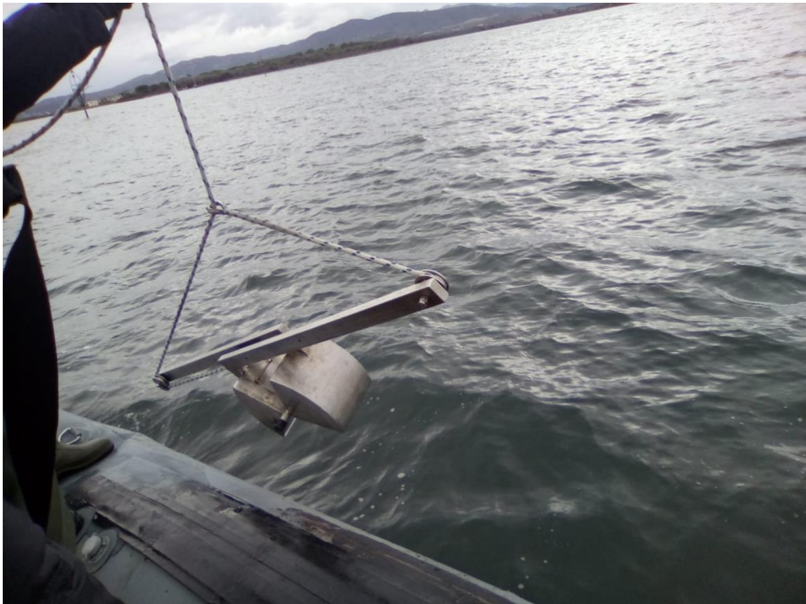
Fig. 14. Benna Van Veen utilizzata per il prelievo dei sedimenti - Benne Van Veen utilisée pour le prélèvement de sédiments.
