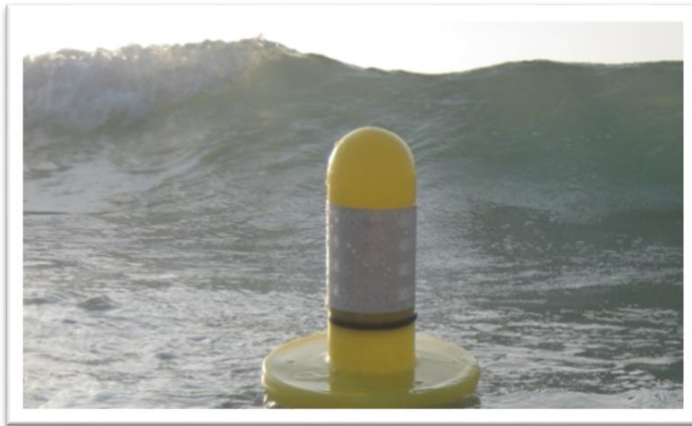
Fig. 2: Drifter costiero in fase di misurazione in acqua bassa - Drifter côtier mesurant en eaux peu profondes.
