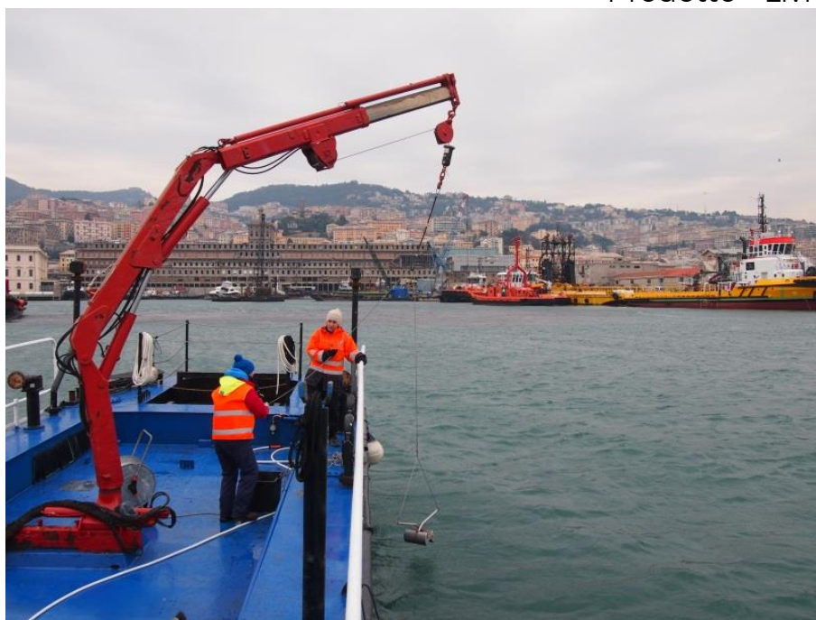
Fig. 9 - Prelievo dei sedimenti mediante benna Van Veen - Prélèvement des sédiments par une benne Van Veen.
