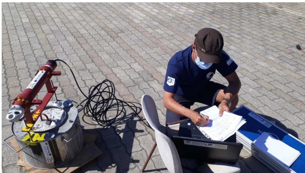
Particolare dello strumento posizionato sul corpo morto durante le procedure di calibrazione della bussola svolte a terra.
