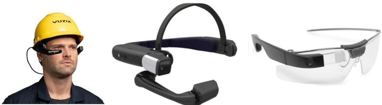
Figura 2: Esempi di dispositivi wearable a realtà aumentata con proiezione delle informazioni ricevute su lenti oppure direttamente sulla retina dell’operatore. Fonte: siti web dei produttori
