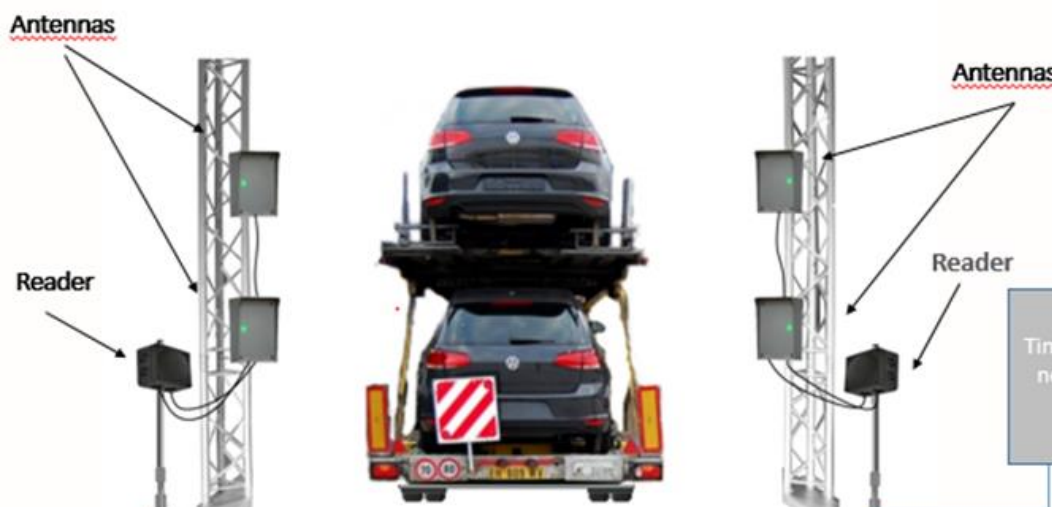
Fig.13 – Gate dotato di sistema RFID
