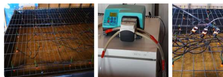
Particolari dell'impianto di irrigazione controllata e pompaggio acque di percolazione
