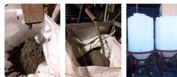
Sabbie grossolane (sinistra) e sabbie fini (destra) e frazioni liquide raccolte in uscita dal trattamento
