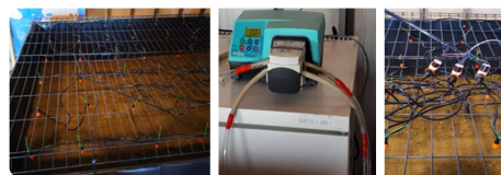
Détails de l'installation d'arrosage contrôlé et du système de pompage de l'eau de percolation
