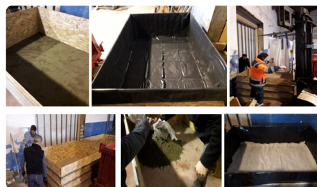
Réalisation et remplissage des lysimètres
