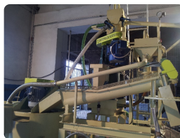
Homogénéisation du mélange à l'intérieur de la pompe et envoi au corps central de séparation
