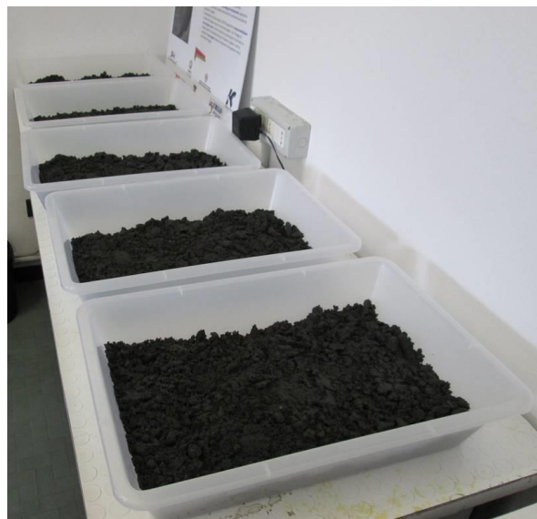
Figure 6.2.4.1. Exemple des 5 bacs numérotés de 1 à 5 utilisées lors des activités de mycoremédiation des sédiments de Gênes, Livourne, Pise, Cagliari et Toulon.
