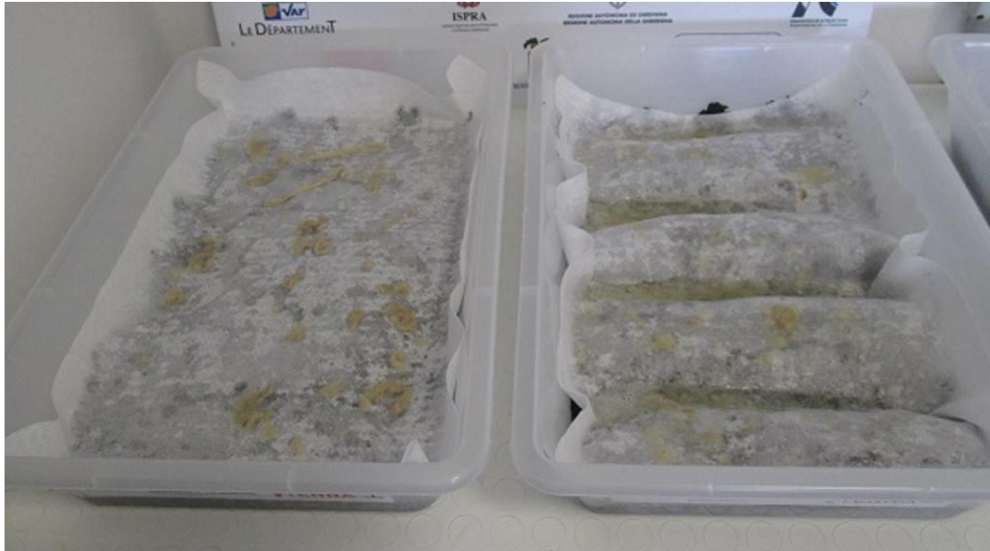
Figure 6.2.4.6 Deux façons différentes de positionner le papier absorbant sur les sédiments du port de Gênes, photo prise après l'inoculation du microchampignon. Bac de gauche : mode de positionnement traditionnel du papier. Bac latéral droit : mode de positionnement du papier absorbant pour augmenter la surface de contact entre le microchampignon et le sédiment.
