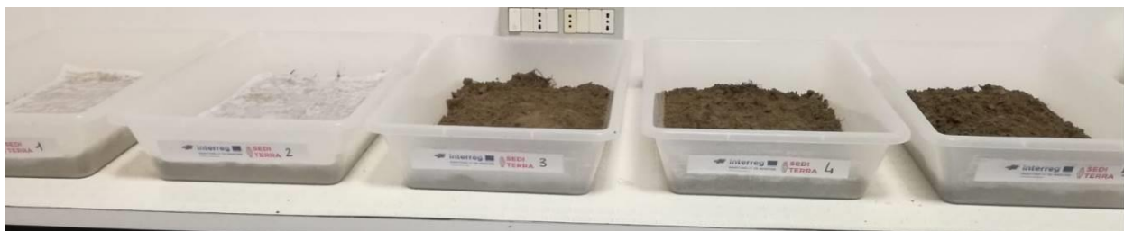
Figure 6.2.4.10 Bacs à la fin de la préparation pour la mycoremédiation - sédiments provenant de Gênes, Livourne, Pise, Cagliari, Toulon. Sur la photo, des bacs préparés avec des sédiments provenant du port de Toulon.
