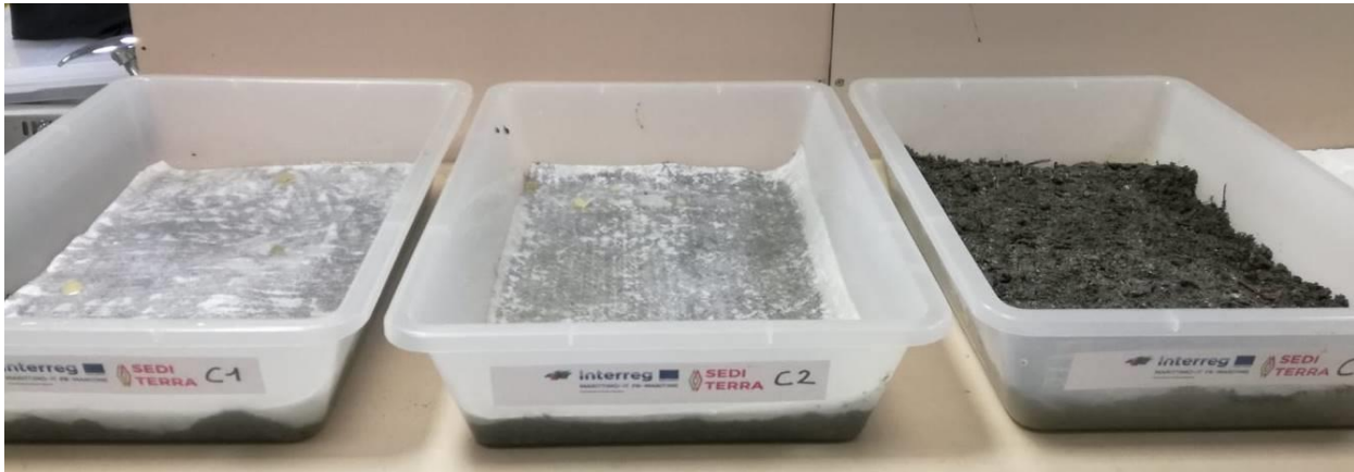
Figure 6.2.4.11 Bacs à la fin de la préparation pour la mycoremédiation - sédiments provenant du port de Centuri.
