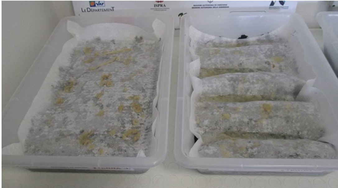
Figura 2.4.6. Due differenti modalità di posizionamento del telo sui sedimenti del porto di Genova, foto realizzata in seguito all'inoculo dei microfunghi. Vaschetta a sinistra : modalità di posizionamento tradizionale del telo. Vaschetta a destra : modalità di posizionamento del telo testata per aumentare la superficie di contatto tra microfunghi e sedimento.
