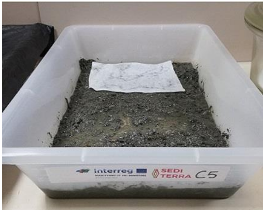
Figura 2.4.9. Vaschetta 5 al termine della preparazione per l'attività di mycoremediation. Nella foto, vaschette preparate con il sedimento proveniente dal porto di Centuri.
