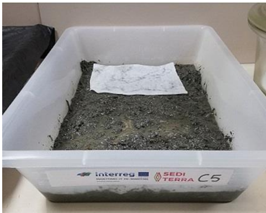
Figure 6.2.4.9 Bac 5 au terme de la préparation de l'activité de mycoremédiation. Sur la photo, des bacs préparés avec des sédiments provenant du port de Centuri.
