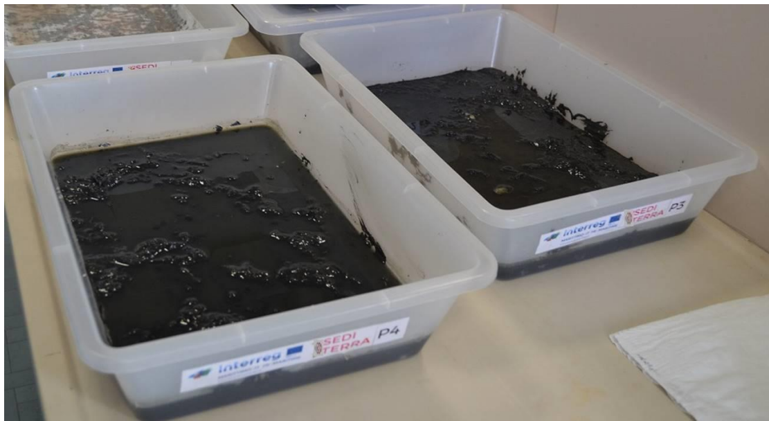
Figura 2.4.8. Vaschette 3 e 4 al termine della preparazione per l'attività di mycoremediation. Nella foto, vaschette preparate con il sedimento proveniente dal Canale dei Navicelli di Pisa.
