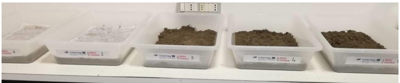
Figura 2.4.10. Vaschette al termine della preparazione per l'attività di mycoremediation - caso dei sedimenti provenienti da Genova, Livorno, Pisa, Cagliari, Tolone. Nella foto, vaschette preparate con il sedimento proveniente dal porto di Tolone.
