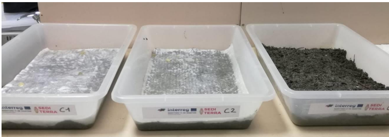
Figura 2.4.11. Vaschette al termine della preparazione per l'attività di mycoremediation - caso dei sedimenti provenienti dal porto di Centuri, in foto.
