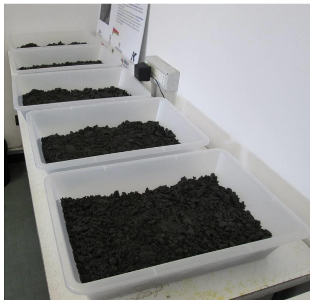
Figura 2.4.1. Esempio delle 5 vaschette numerate da 1 a 5 utilizzate durante le attività di mycoremediation dei sedimenti provenienti da Genova, Livorno, Pisa, Cagliari e Tolone. Nella foto : vaschette contenenti il sedimento del porto di Genova.
