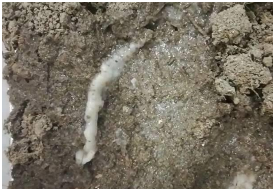
Figura 4.4.4.1. Microfungo inoculato nei sedimenti del porto di Cagliari presenti nella vaschetta 3 il giorno dell'allestimento del laboratorio per l'attività di mycoremediation.
