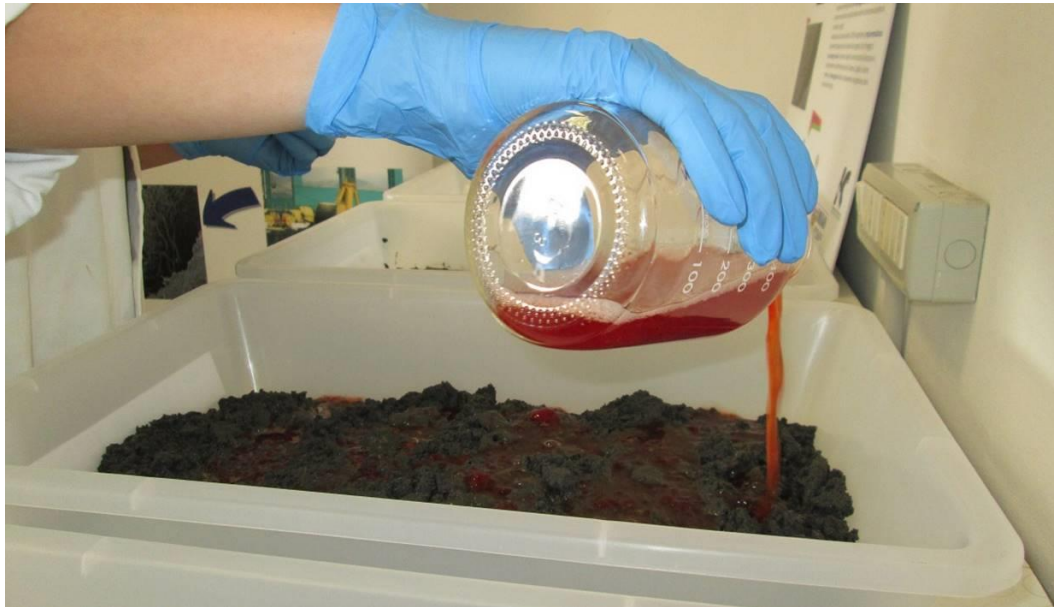
Figure 6.2.4.7 Inoculum de microchampignons dans les sédiments des bacs 3 et 4. Sur la photo, sédiments du port de Gênes.
