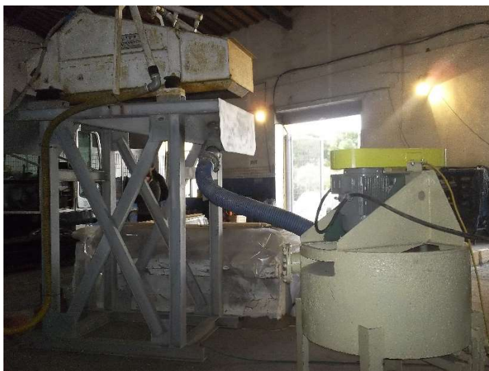
Photo 2- Crible vibrant et pompe d'homogénéisation
