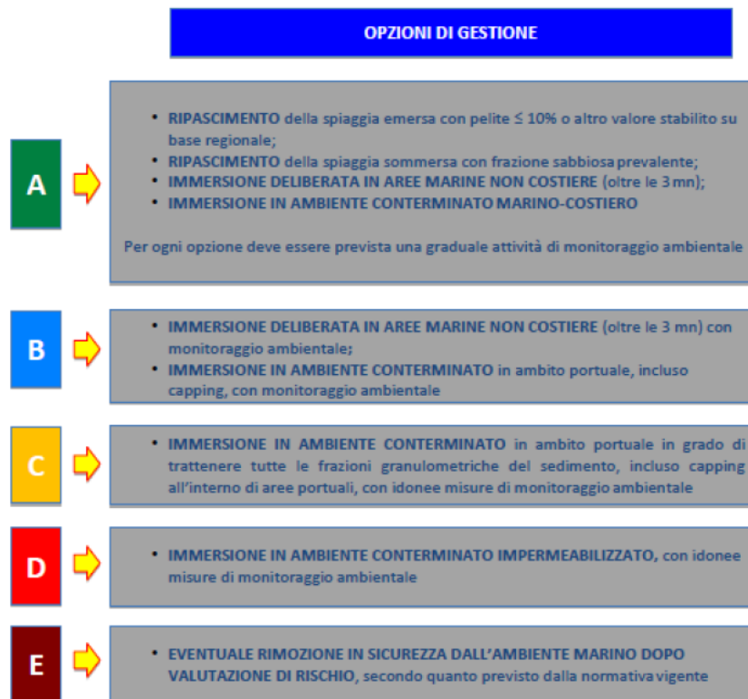
Figura 7 - Opzioni di gestione compatibili con la classificazione della qualità dei materiali da dragare.
