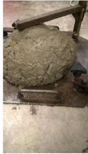
Figura 19 – Calcestruzzo 43604-G allo stato fresco / Figura 20 – Calcestruzzo 43604-H allo stato fresco
