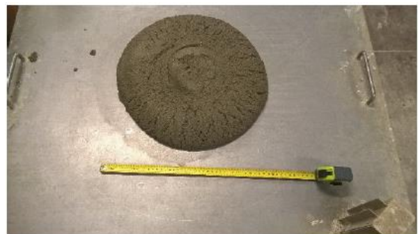
Figure 15 – Illustration du mortier 43604-D à l'état frais
