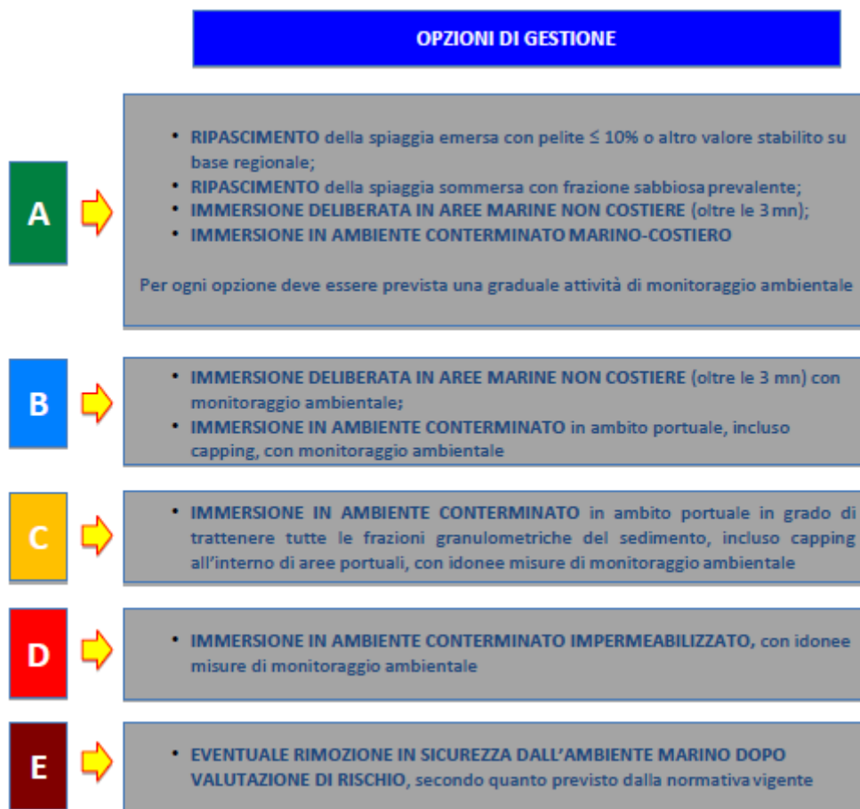
Figure 7 - Options de gestion compatibles avec la classification de la qualité des matériaux à draguer
