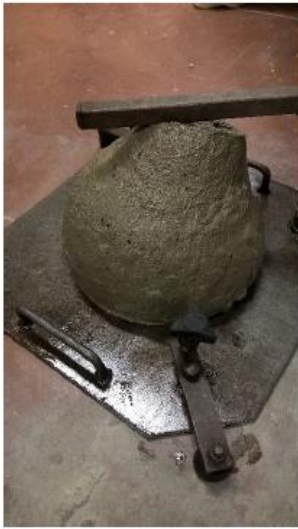
Figure 19 – Illustration du béton 43604-G à l'état frais
