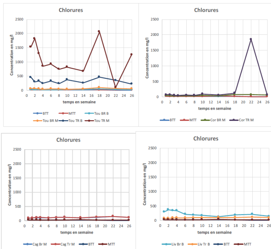
Figura 41 – Evoluzione della concentrazione di cloruri negli eluiti delle lastre dei diversi materiali testati
