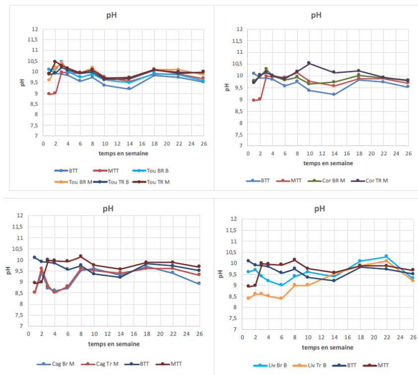
Figura 39 – Evoluzione del pH negli eluiti delle lastre dei diversi materiali testati
