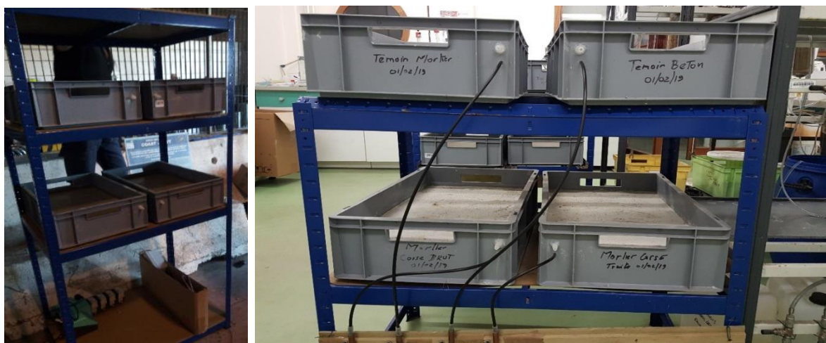
Figure 28 – Dalles pilotes mortier et béton mis en œuvre à Livourne (gauche) et à Toulon (droite)
