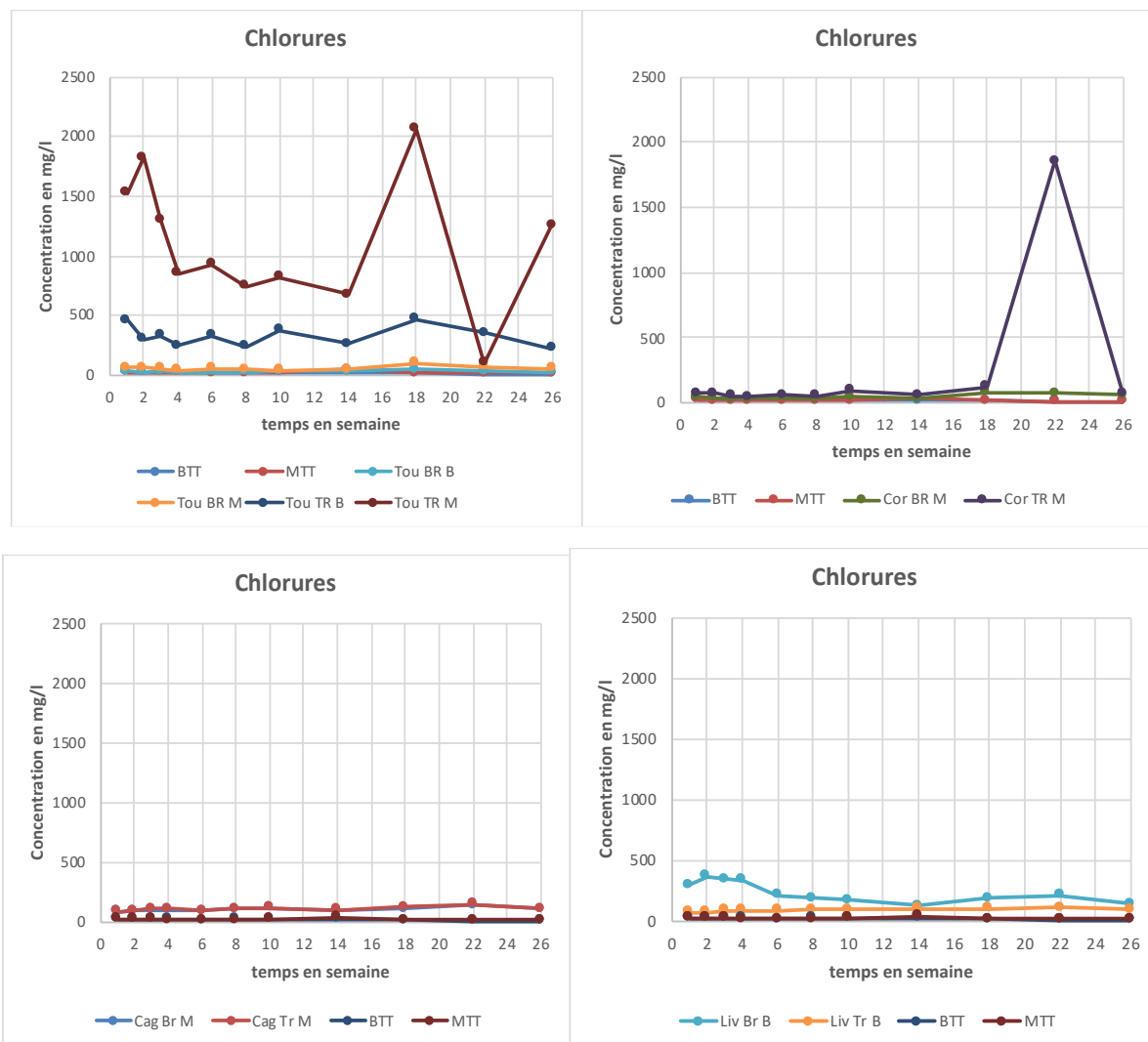
Figure 41 – Évolution de la concentration en chlorures dans les éluats de dalles des différents matériaux testés
