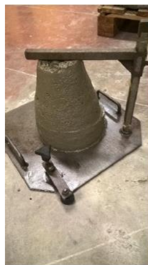
Figure 18 – Illustration du béton 43604-F à l'état frais
