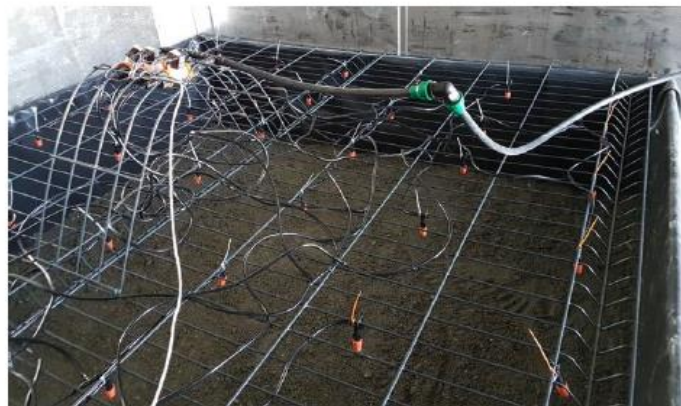
Figura 27 – Sistema di irrigazione posto sul lisimetro
