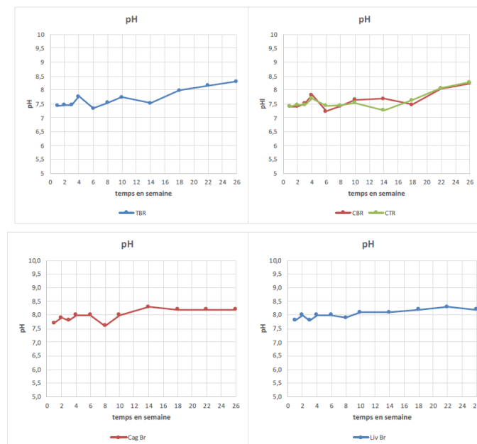
Figura 32 – Evoluzione del pH degli eluti del lisimetro dei diversi sedimenti testati
