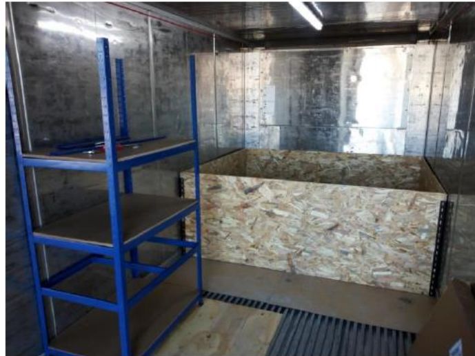
Figura 29 - Dispositivo di accoglienza delle lastre sperimentali e del lisimetro all'interno di un contenitore refrigerato nel CPEM di Tolone
