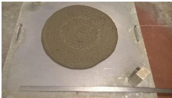
Figure 12 – Illustration du mortier 43604-A à l'état frais
