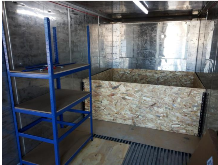
Figure 29 – Dispositif d'accueil des dalles pilote et du lysimètre dans un conteneur réfrigéré sur le CPEM de Toulon
