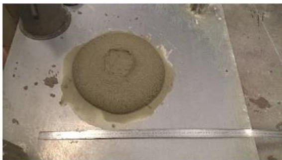
Figura 14 – Malta 43604-C allo stato fresco / Figura 15 – Malta 43604-D allo stato fresco
