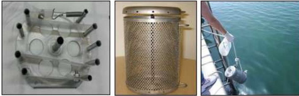
Figura 7. Spiders e canister utilizzati per l'esposizione dei SR
