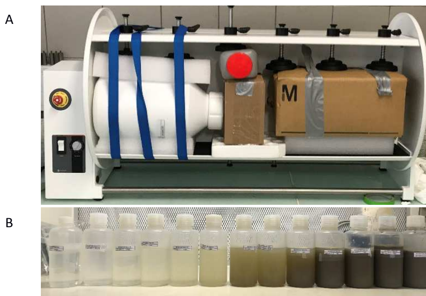
Figura 6 . Agitatore rotante utilizzato per garantire una miscelazione costante e riproducibile (A) e un gradiente dei rapporti sedimenti/acqua utilizzati per simulare diverse intensità di risospensione nell'area portuale (B).
