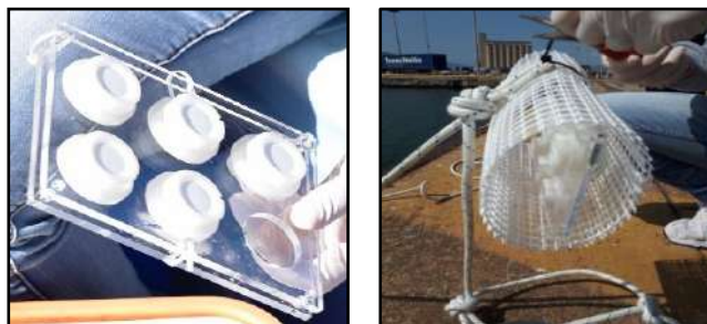
Figura 6. Supporti in plexiglass e rete di protezione utilizzati per l'esposizione dei DGT.
