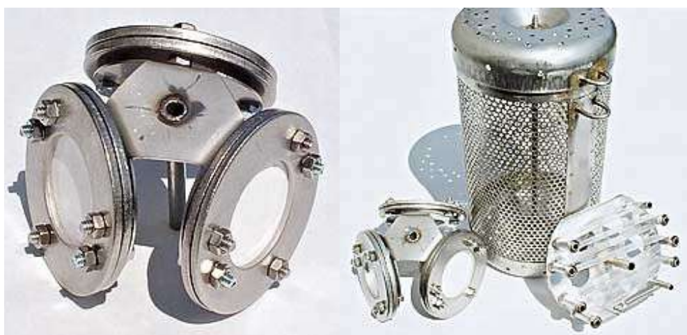
Figura 8. Supporti e canister utilizzati per l'esposizione dei POCIS.
