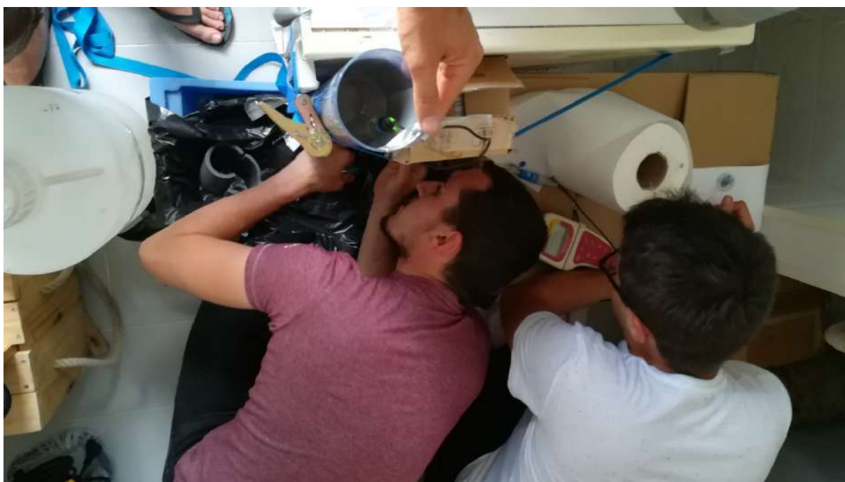
Figura 10. Misura di Eh nei sedimenti utilizzando un elettrodo di perforazione inseriti nei buchi del tubo perforato e con l'elettrodo di riferimento immerso nell'acqua supernatante
