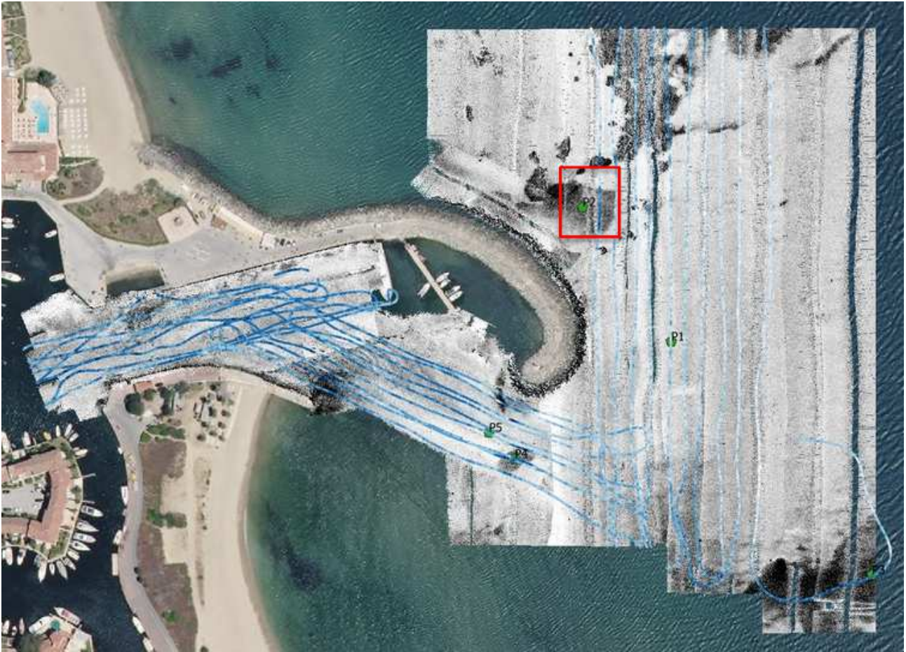
Figura 19 - Classificazione sedimentare generata a partire dall'incrocio del rilevamento geofisico della valigia SE.D.RI.PORT e dei prelievi sedimentari
