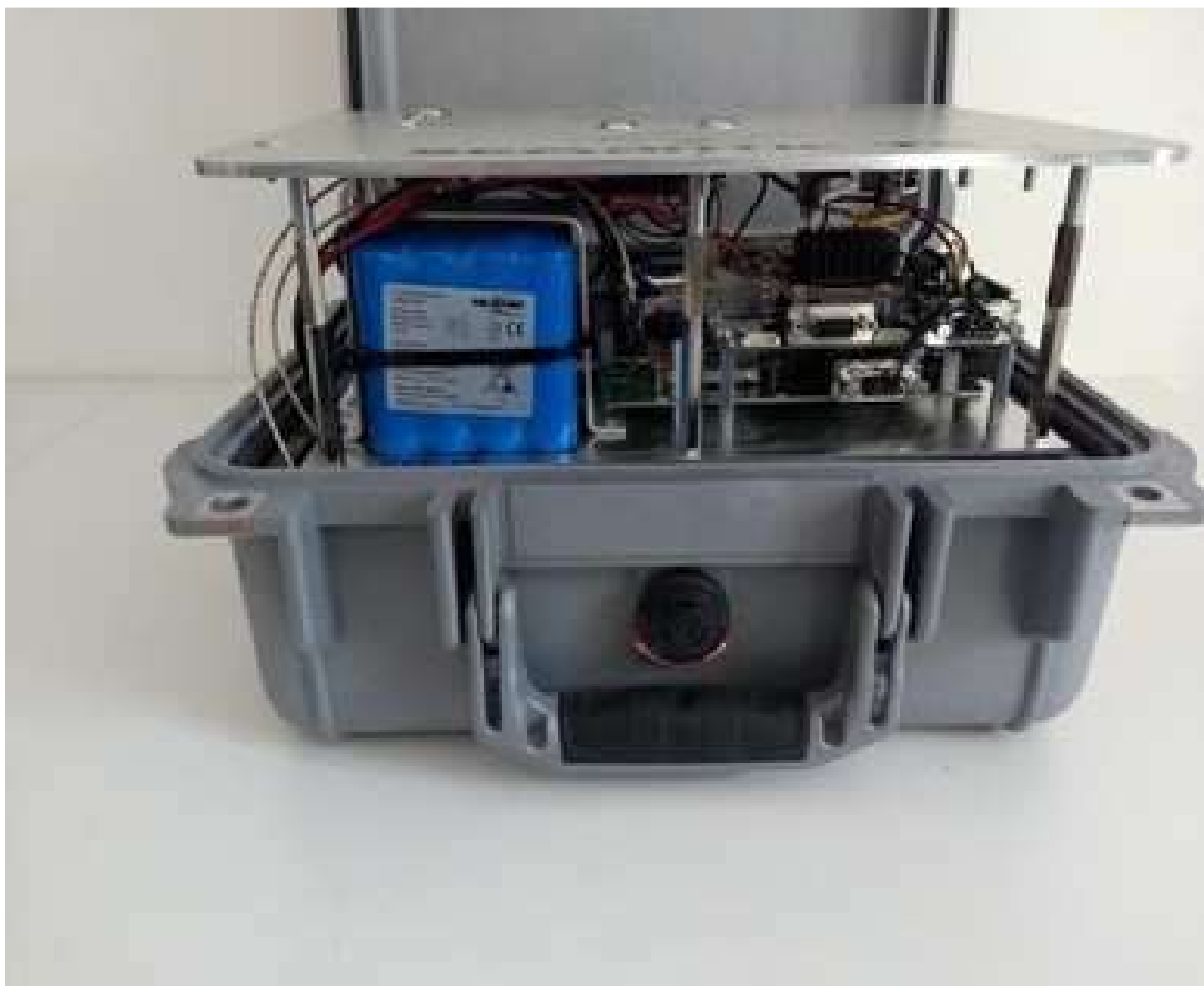
Figura 22 - Integrazione hardware della valigia SE.D.RI.PORT
