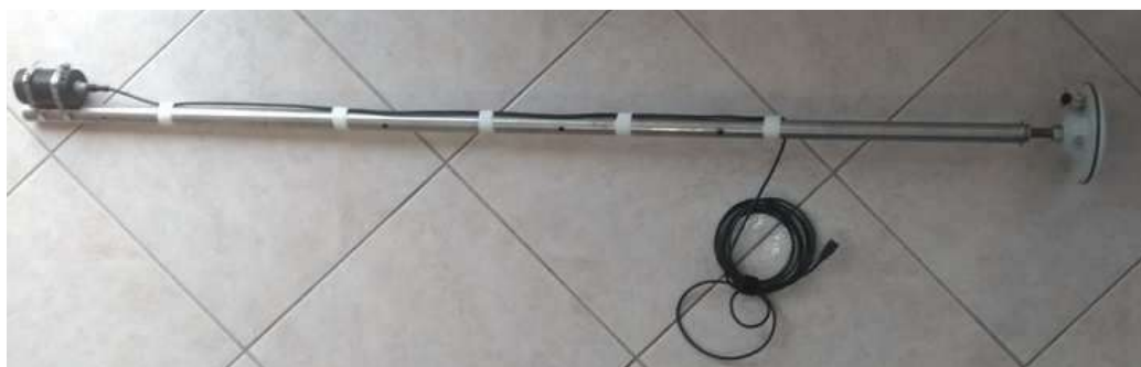
Figura 12 - Asta telescopica con gli strumenti fissati alle estremità
