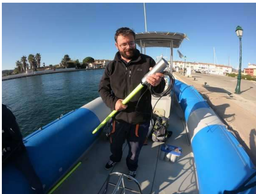
Figura 35 - Asta telescopica con eBeam e antenna GPS
