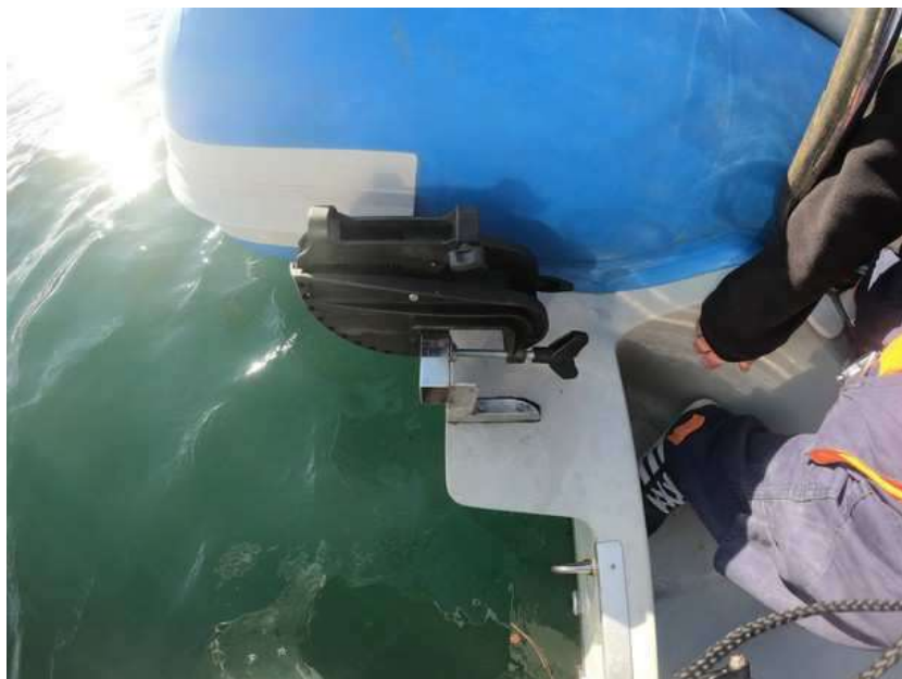
Figura34 - Sistema di fissaggio adattabile su qualsiasi nave di opportunità
