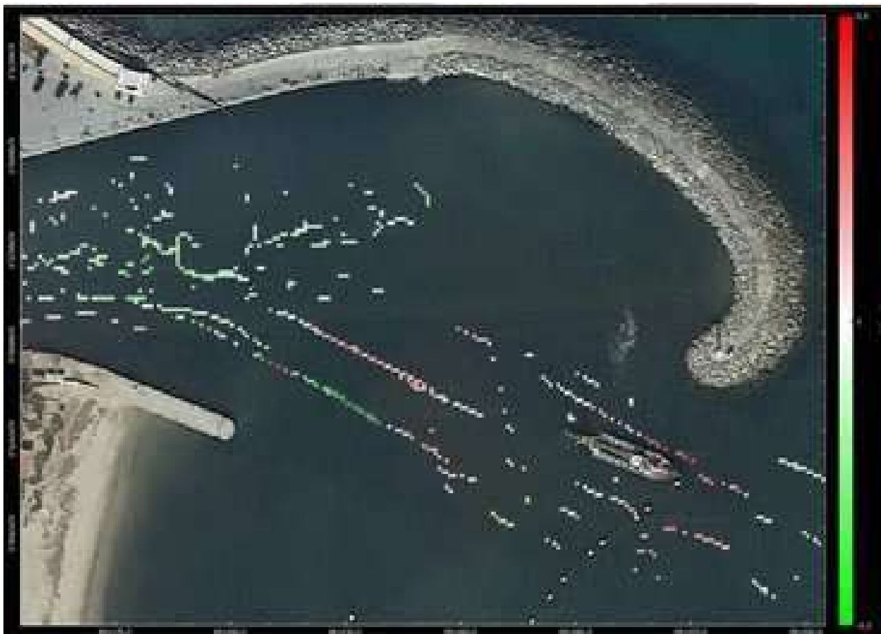
Figura 40 - Variazione di profondità ai punti d'intersezione tra le acquisizioni del 2018 e del 2019: le perdite sono indicate in rosso, gli apporti in verde
