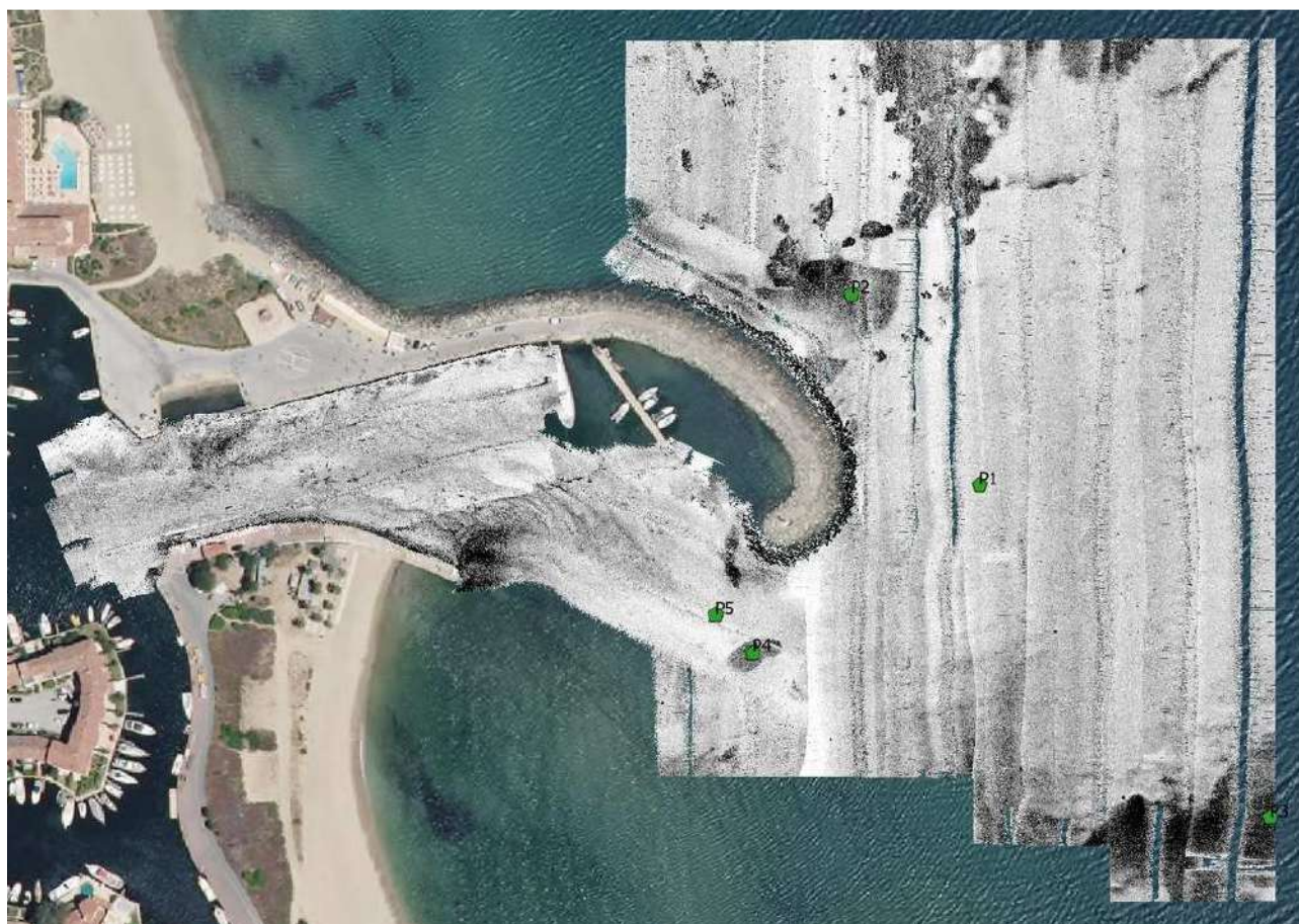
Figura 18 - Punti di prelievo sedimentario su fondale del mosaico sonar
