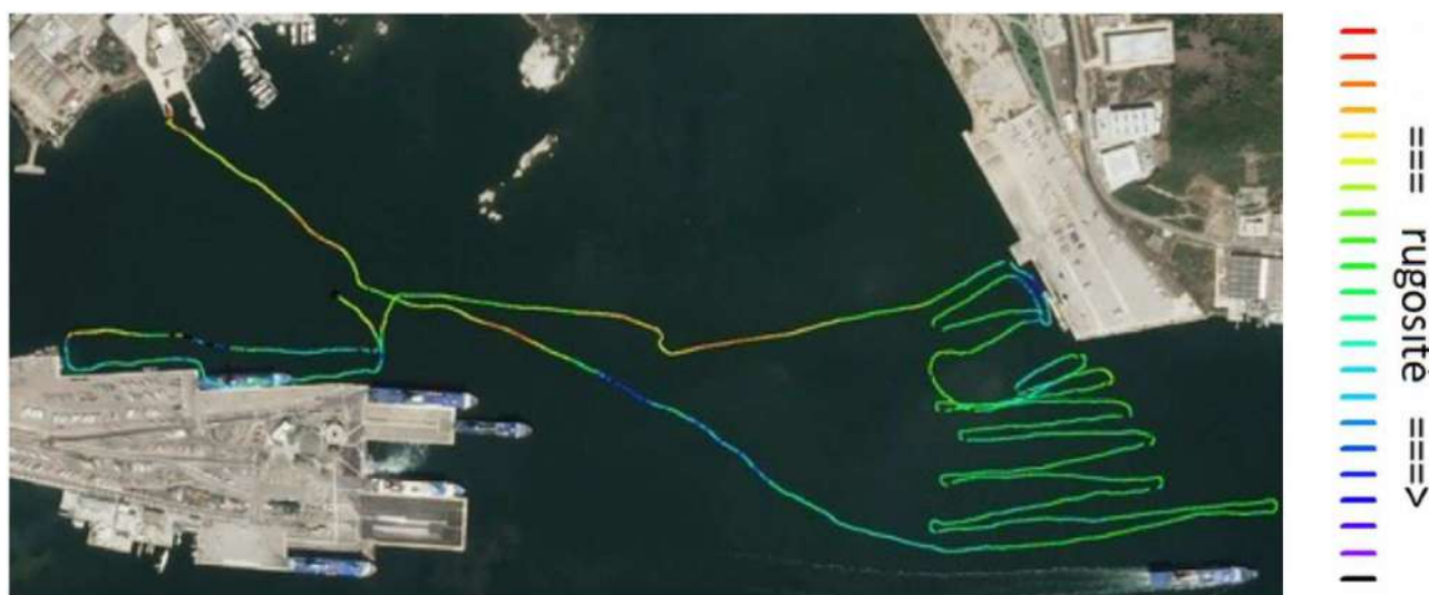
Figura 30 - Rugosità dei fondali rilevate a partire dal rilevamento geofisico della valigia SE.D.RI.PORT
