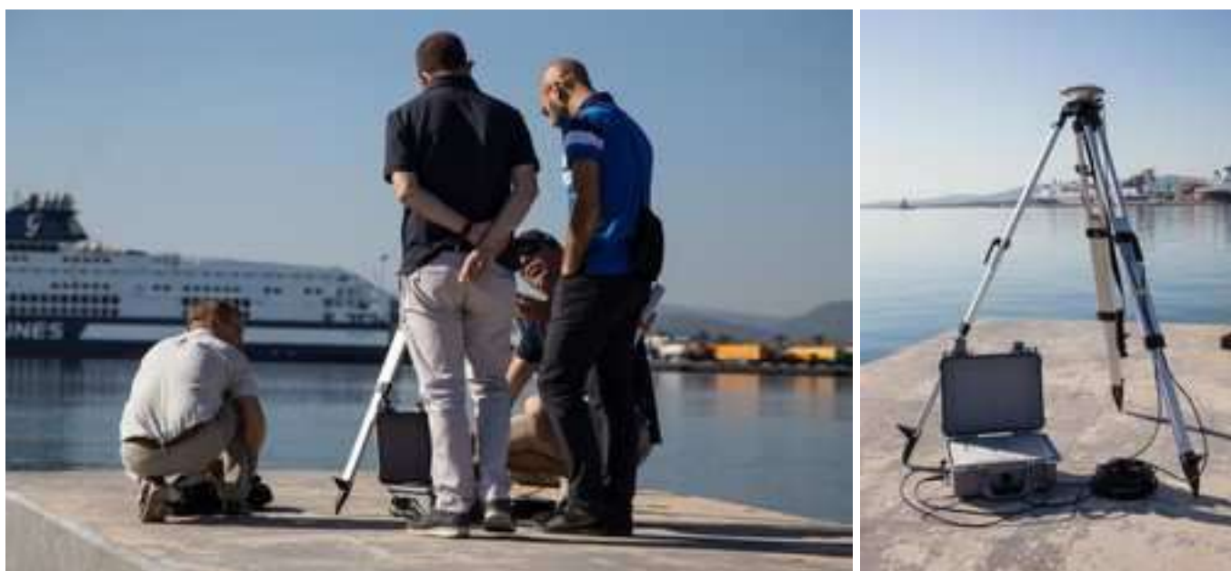
Figura 24 - Installazione della valigia base
