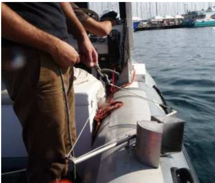
Figura 8 - Armamento della benna in superficie
