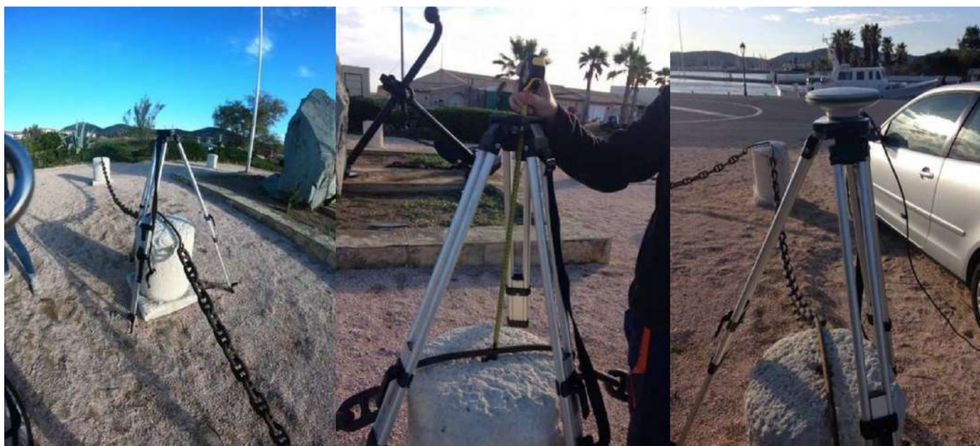
Figura 31 - Installazione della base SE.D.RI.PORT nel punto di riferimento
