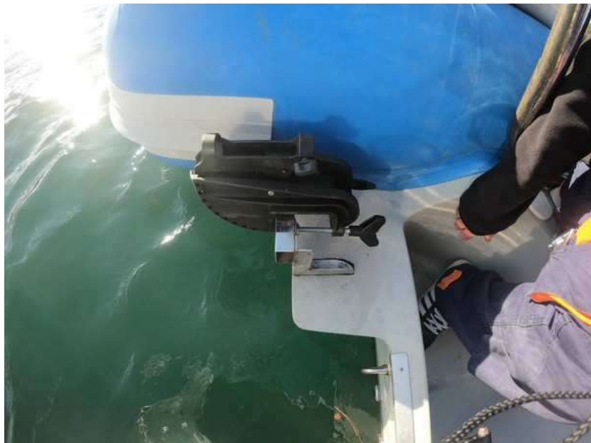
Figure 34 - Système de fixation adaptable sur tout navire d'opportunité
