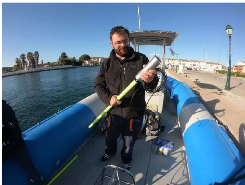
Figure 35 - Perche télescopique avec eBeem et antenne GPS
