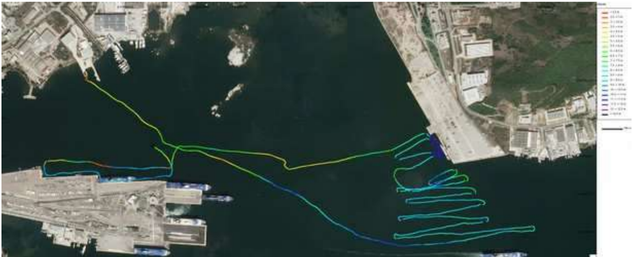
Figure 29 - Profondeurs relatives au sondeur relevées à partir du levé géophysique valise SE.D.RI.PORT
