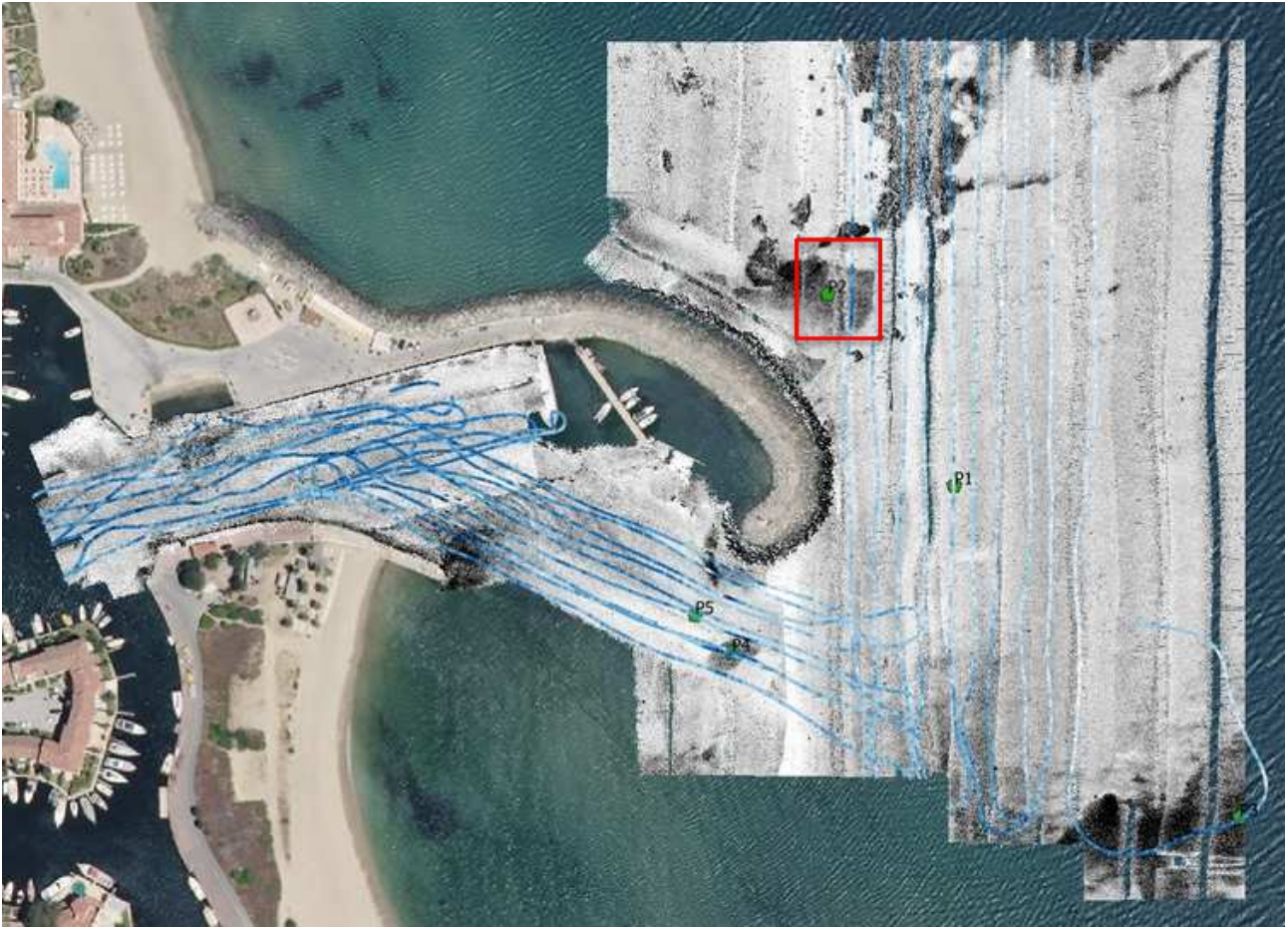
Figure 19 - Classification sédimentaire générée à partir du croisement du levé géophysique valise SE.D.RI.PORT et des prélèvements sédimentaires
