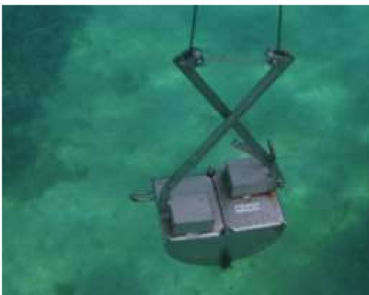
Figure 9 - Remontée de la benne déclenchée
