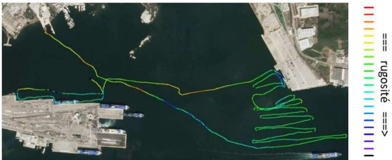
Figure 30 - Rugosité des fonds relevées à partir du levé géophysique valise SE.D.RI.PORT
