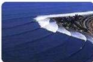
Figure 4 : Diffraction sur un cap
